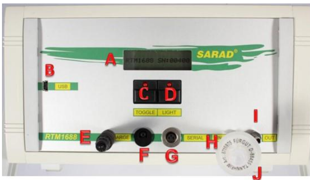
Figura 3-1 Esquema de los principales elementos y conexiones del monitor RTM 1688-2 [43]
