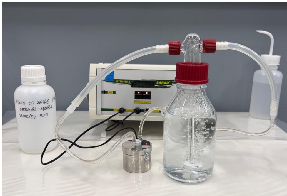
Figura 3-9 Monitor midiendo radón de la muestra de agua – Elaboración propia
