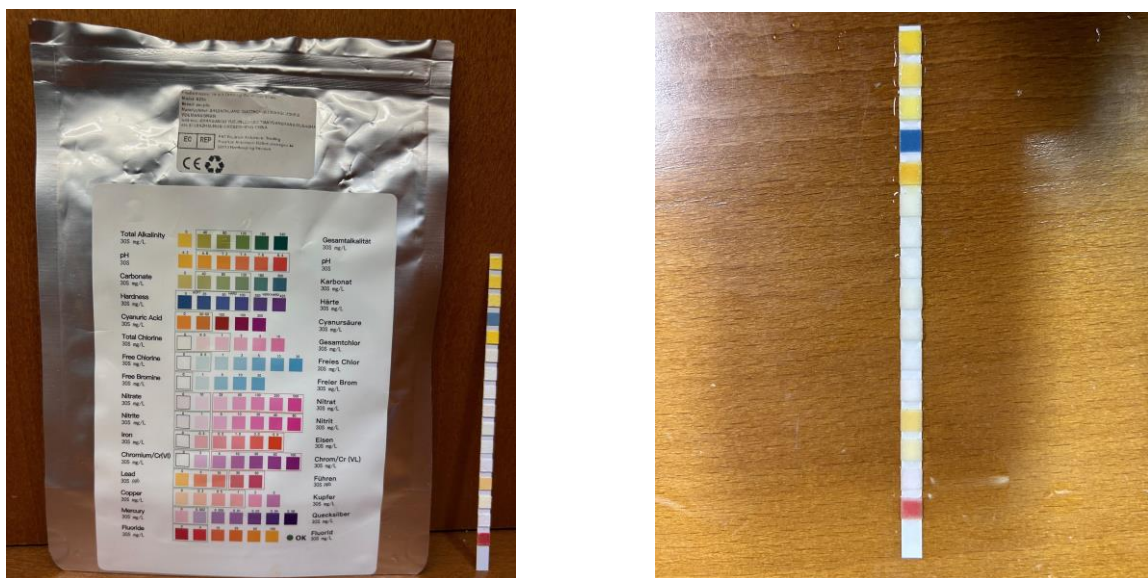
Figura 3-11 Izquierda: Leyenda de las bandas colorimétricas en la bolsa. Derecha: Banda colorimétrica tras permanecer 30 segundos en una muestra de agua
