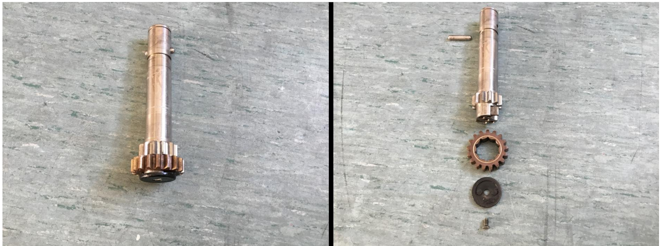
Figura 3-7. Huso principal montado (izquierda) y desmontado (derecha).
