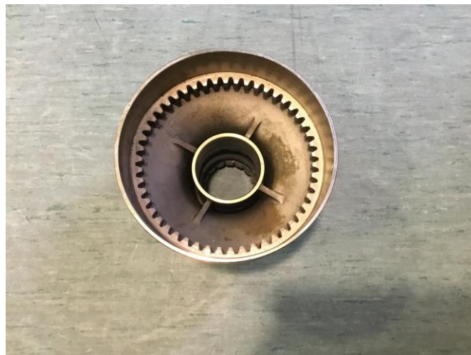
Figura 3-4. Rueda interior dentada del tambor.
