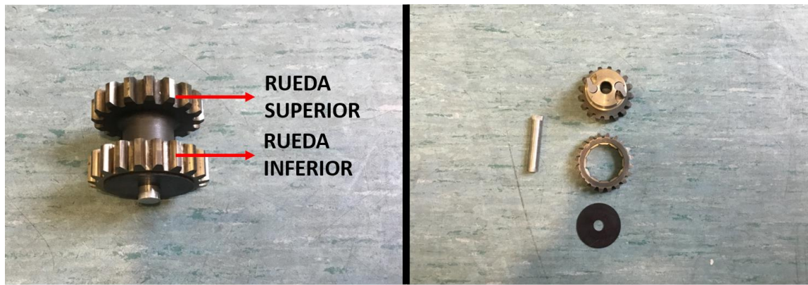
Figura 3-22. Eje 1 montado (izquierda) y desmontado (derecha)
