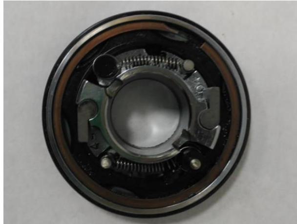
Figura 3-18. Botón desactivado. Trinquetes cerrados (Fuente: [34]).
