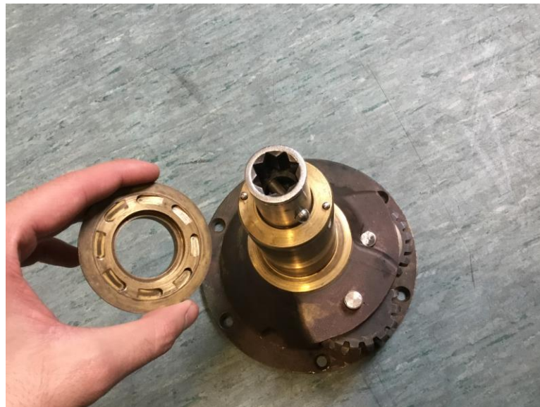
Figura 3-21. Estrías del plato de embrague en cara inferior.
