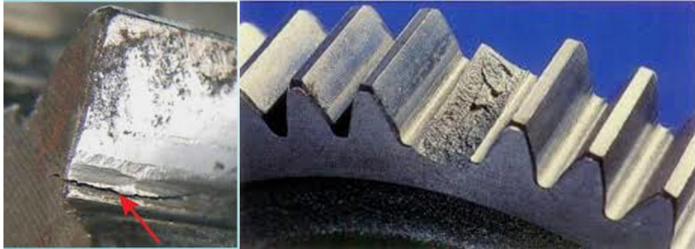
Figura 3-39. Grieta en la base del diente (izquierda) y ruptura total de un diente (derecha) (Fuente: [42]).
