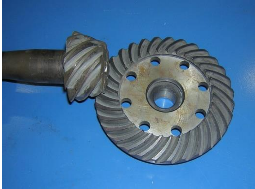
Figura 2-23. Engranaje cónico helicoidal (Fuente: [10]).
