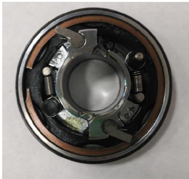
Figura 3-17. Botón presionado. Trinquetes abiertos (Fuente: [34]).
