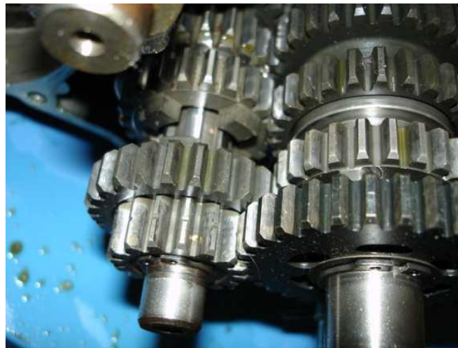
Figura 2-16. Engranaje cilíndrico recto de una caja de cambios de una motocicleta (Fuente: [13]).
