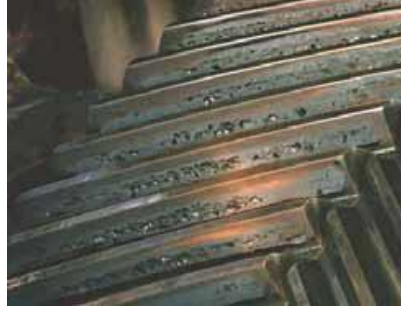
Figura 3-38. Picadura en flanco de dientes (Fuente: [39]).
