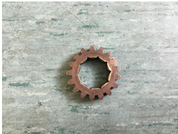
Figura 3-11. Rueda inferior del huso principal.
