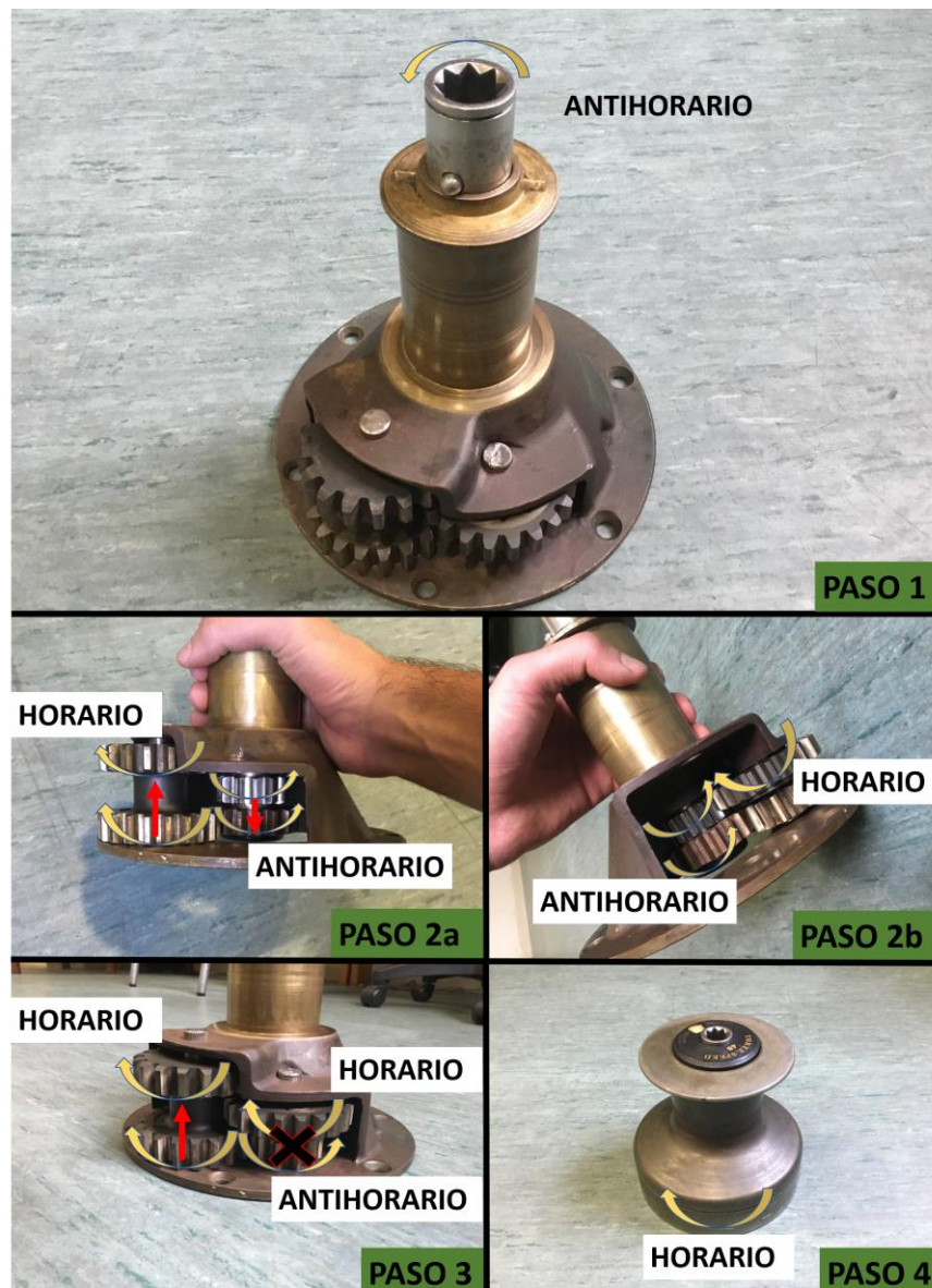
Figura 3-33. Esquema de la segunda velocidad.
