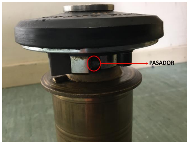
Figura 3-19. Tapa superior embragada con el pasador del huso principal.
