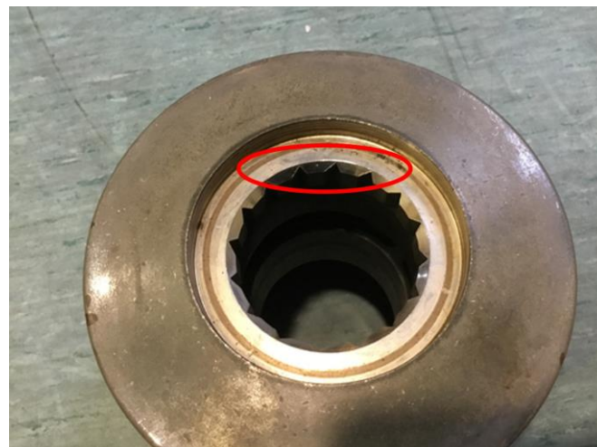
Figura 3-5. Muecas de la parte superior del tambor.
