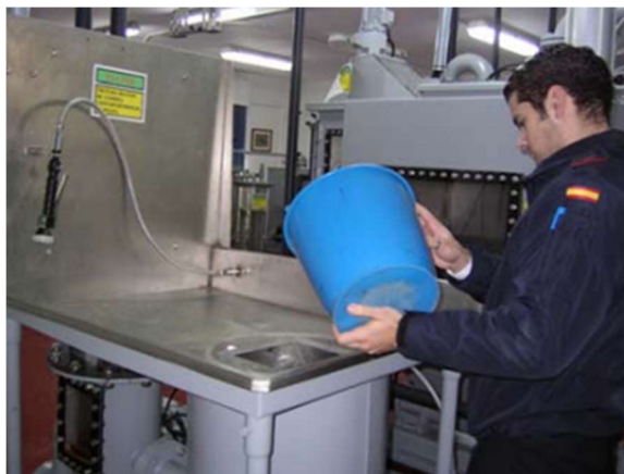
Figura 2-7 Los restos de comidas se introducen en trituradores en los buques de la Armada.
