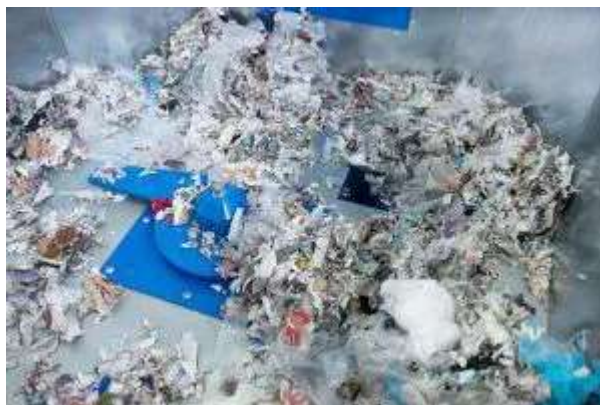
Figura 3-46 Biomasa residual triturada entrando en una briquetadora.
