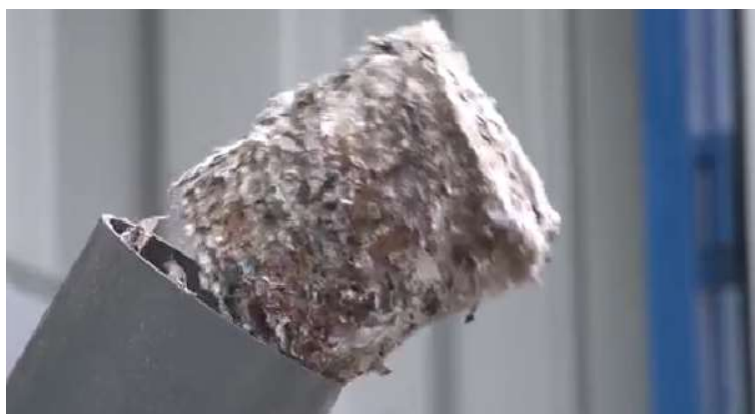
Figura 3-41 Proceso de briqueteado de residuos sólidos por una briquetadora para buques [49].
