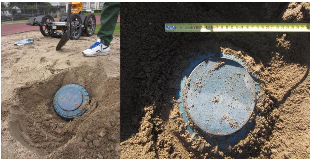
Figura 5-2 Izquierda: Proceso de enterramiento de la mina. Derecha: dimensiones de la mina.
