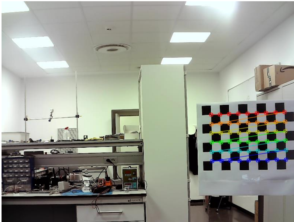
Figura 3-19 Proceso de calibración para el cálculo de la matriz y coordenadas (autoría propia)
