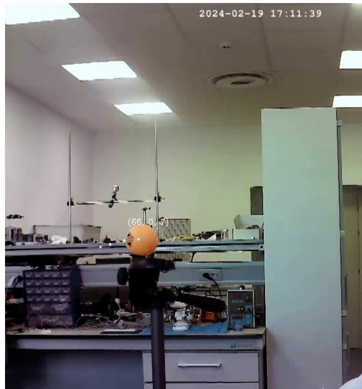
Figura 3-20 Imagen capturada desde la cámara izquierda, mostrando la trayectoria de la pelota y las coordenadas 3D en ese momento (autoría propia)
