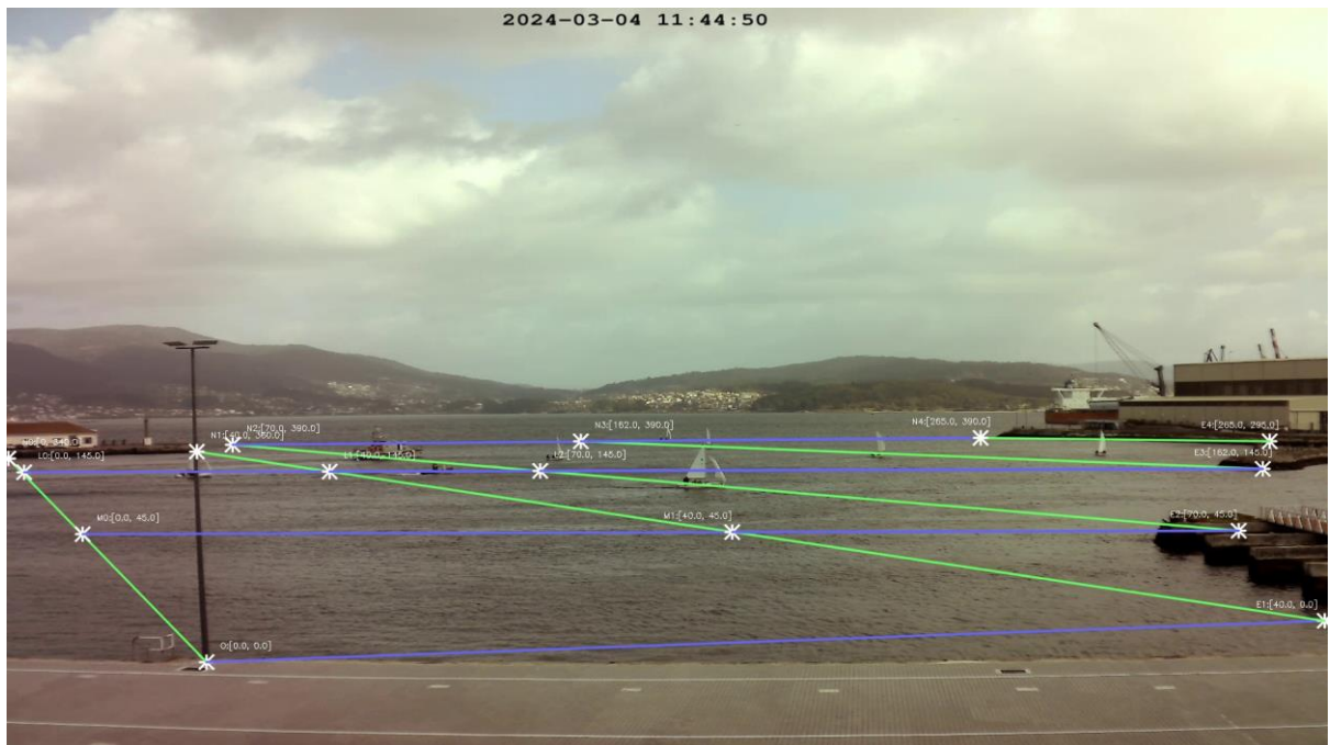
Figura 3-27 Malla obtenida con respecto a la cámara izquierda (autoría propia)
