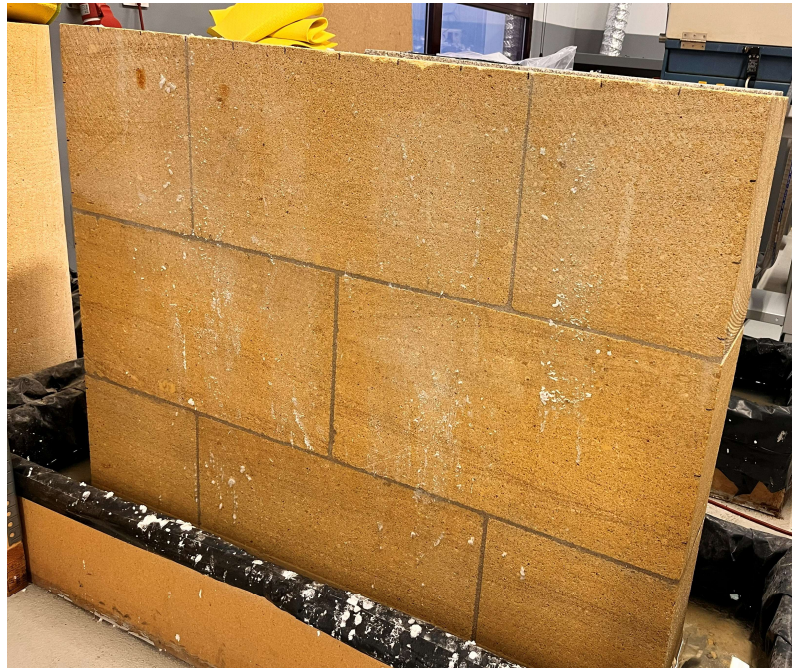
Figura 3-2 Muro de calcarenita empleado en el desarrollo del trabajo. Elaboración propia.
