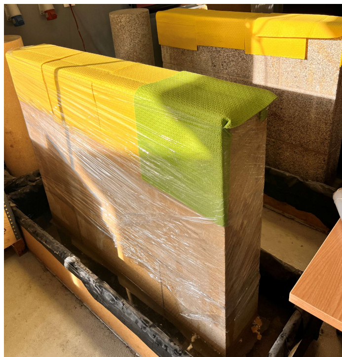
Figura 3-4 Imagen de ambos muros mientras se humedecían tanto por la parte superior con los trapos como con el agua de la parte inferior. Elaboración propia.
