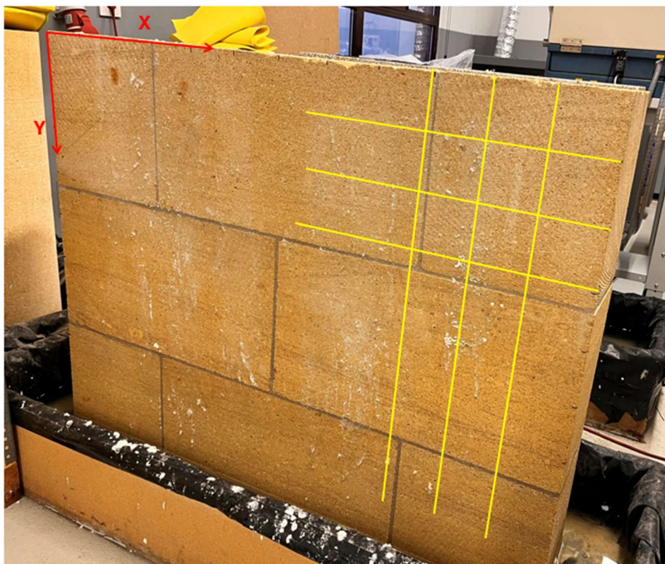
Figura 3-6 Muro de calcarenita en los que se realizan los ensayos con un ejemplo de la retícula en la que se realizan las mediciones con el protímetro, además de la distribución del eje xy que se usa como referencia. Elaboración propia.
