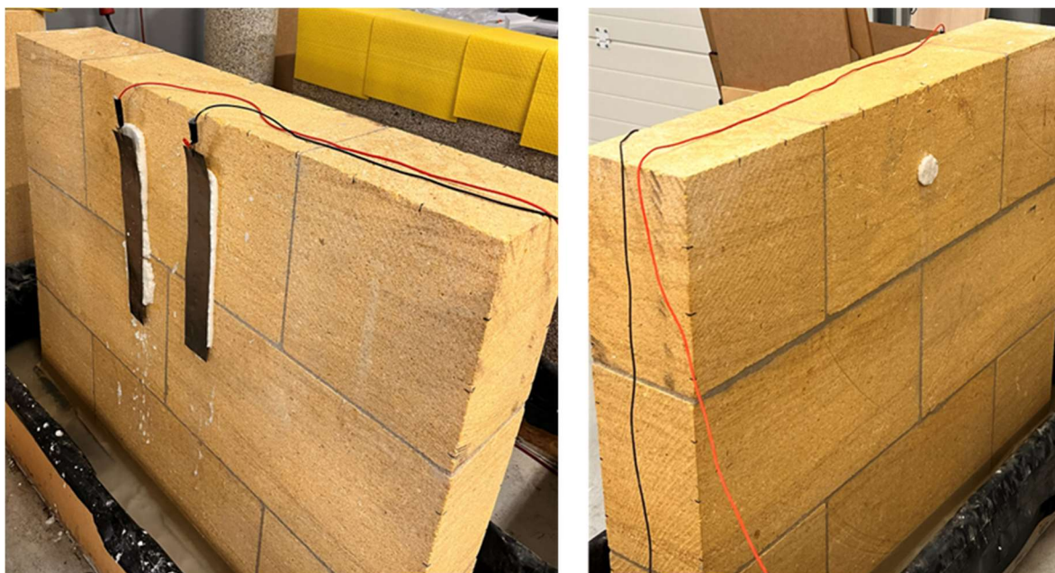
Figura 3-10 Colocación de la papeta de celulosa y sales colocada en la cara contraria a los electrodos durante los ensayos. Elaboración propia.
