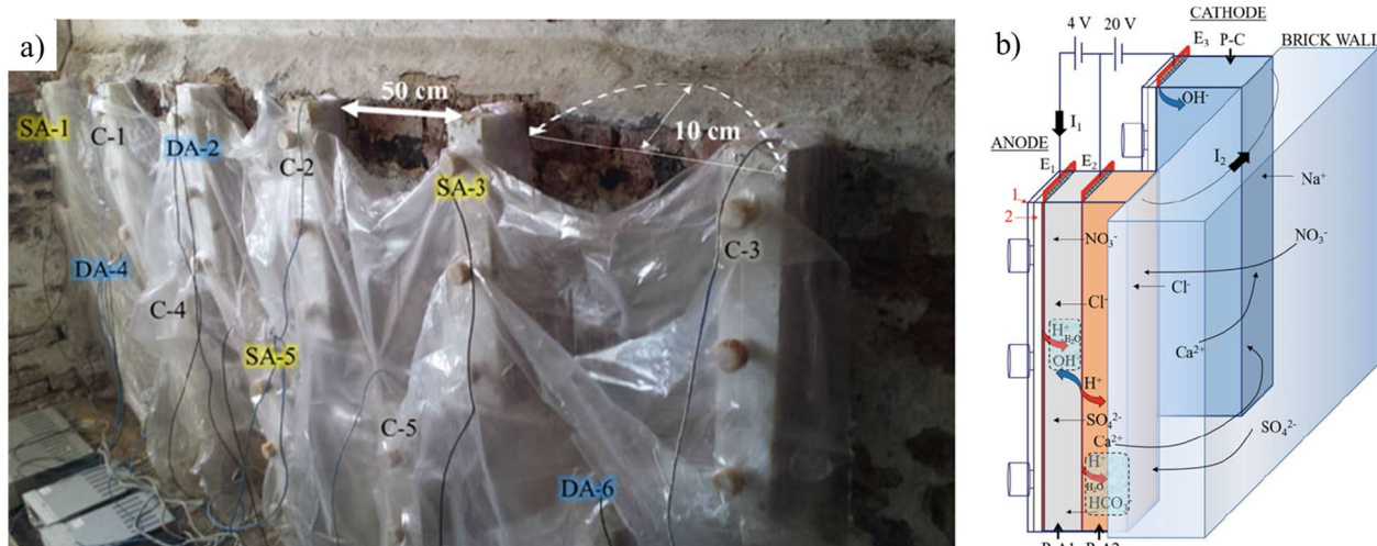
Figura 1-2 Colocación de electrodos sobre la misma superficie de la pared (a) y esquema donde se muestra la profundidad de penetración del campo (b). Imagen extraída de [24].
