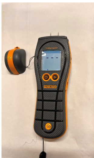
Figura 3-5 Imagen del protímetro empleado durante la medición de humedad. Elaboración propia.
