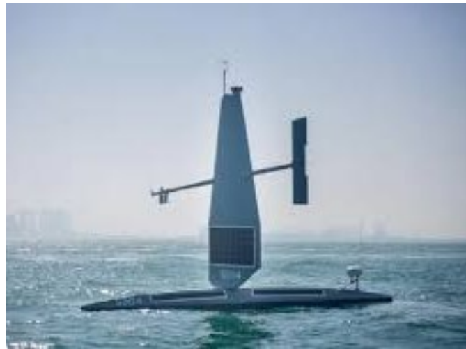
Figura 2-16.- Dron de estudio oceánico “SAILDRONE”
