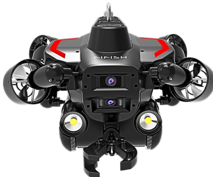
Figura 2-18.- Dron de salvamento submarino “QYSEA FIFISH RESCUE”
