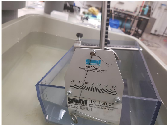
Imagen 7-6 Escora final peso fijo
