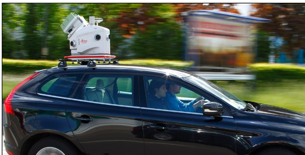
Figura 2-7 Altimetro láser móvil acoplado a un vehículo [16]
