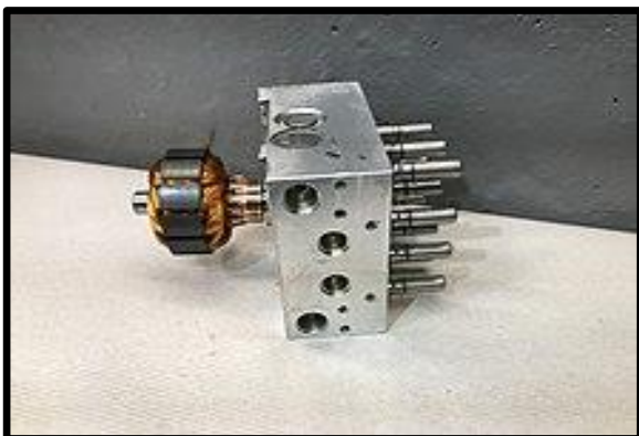
Figura 2-6 Unidad de control hidráulica de 4 canales y 12 válvulas
