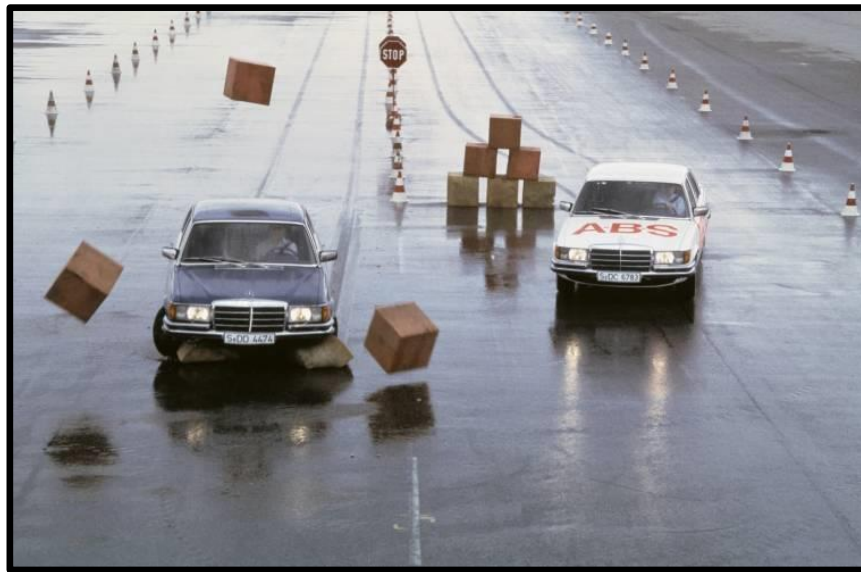
Figura 1-1 Comparativa frenada Mercedes-Benz clase S con y sin ABS [4]
