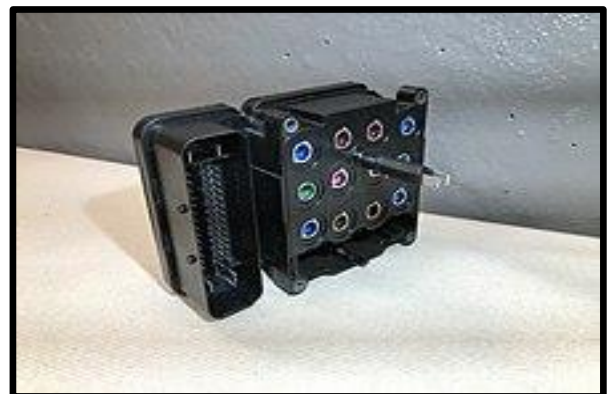
Figura 2-7 Unidad de control electrónica de 4 canales y 12 válvulas
