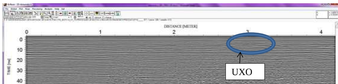
Figura 5-13 Datos GPR después de aplicar la ganancia
