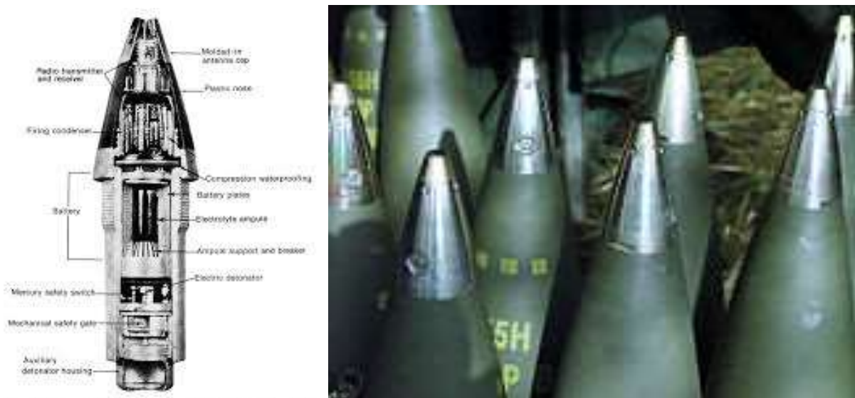
Figura 2-4 Bisección de una espoleta Q (izquierda) y espoletas alojadas en los proyectiles 155mm (derecha) [10]
