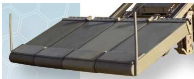
Figura 4-2 Visor 2500 GPR de NIITEK [58]
