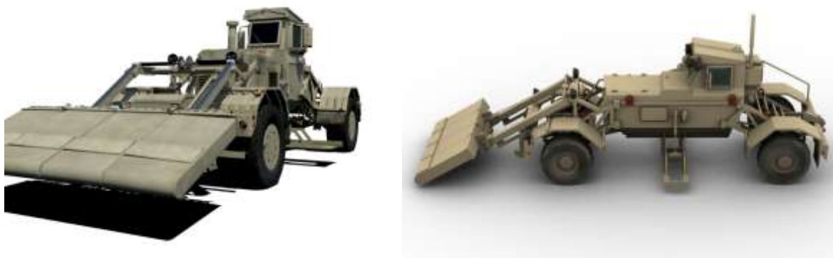
Figura 4-1 El Husky (2G VMMD) desarrollado por DCD Protected Mobility [57]
