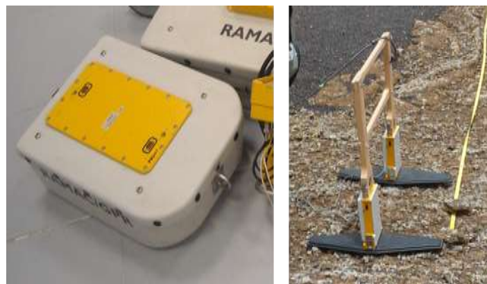
Figura 3-6 Antena biestática apantallada de 500 Mhz (izquierda) y antena biestática de 200 Mhz sin apantallar (derecha)
