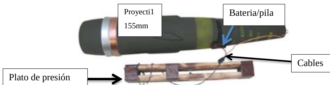
Figura 2-12 Montaje habitual de un IED con un plato de presión
