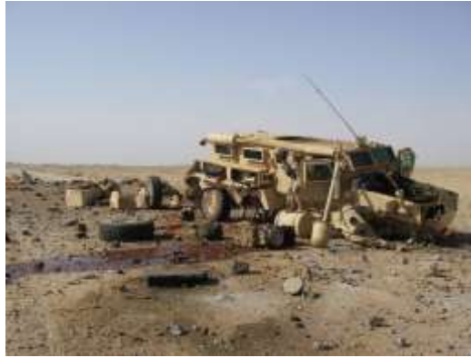
Figura 2-2 Efectos de un IED sobre un vehículo MRAV (Mine Resistant Anti-Ambush Vehicle) [9]
