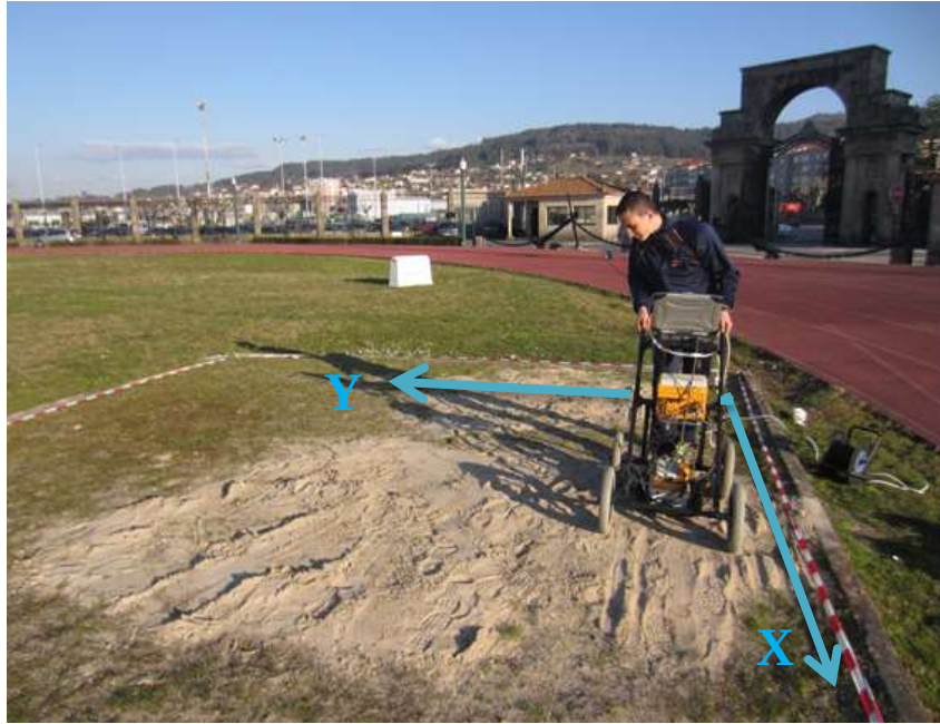
Figura 5-4 Obtención de los datos GPR en la zona experimental
