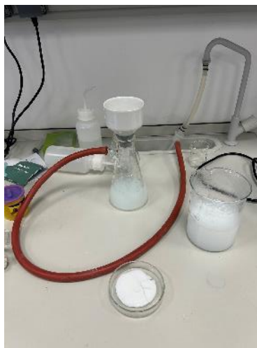
Figura 3-3 Sistema de filtrado [Autoría propia]
