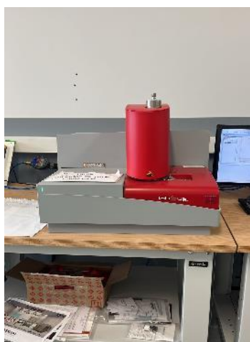
Figura 3-13 Analizador termogravimétrico [Autoría propia]
