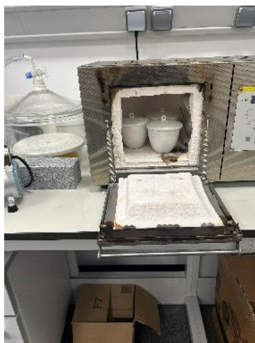
Figura 3-9 Muestras en la mufla para el calcinado [Autoría propia]
