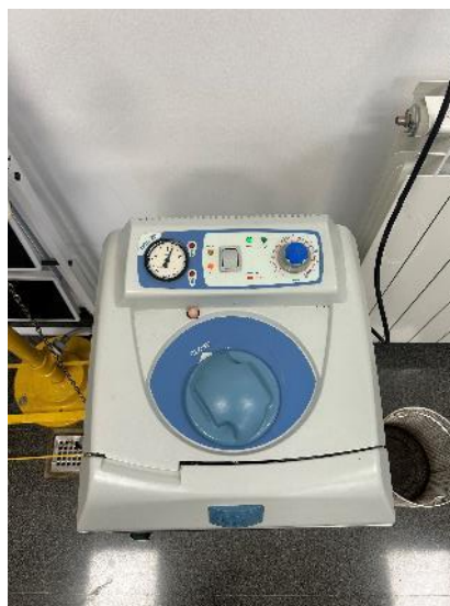
Figura 3-6 Autoclave trabajando a temperatura y presión [Autoría propia]
