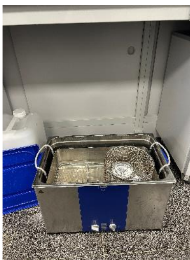
Figura 3-10 Muestras en el baño de ultrasonido [Autoría propia]
