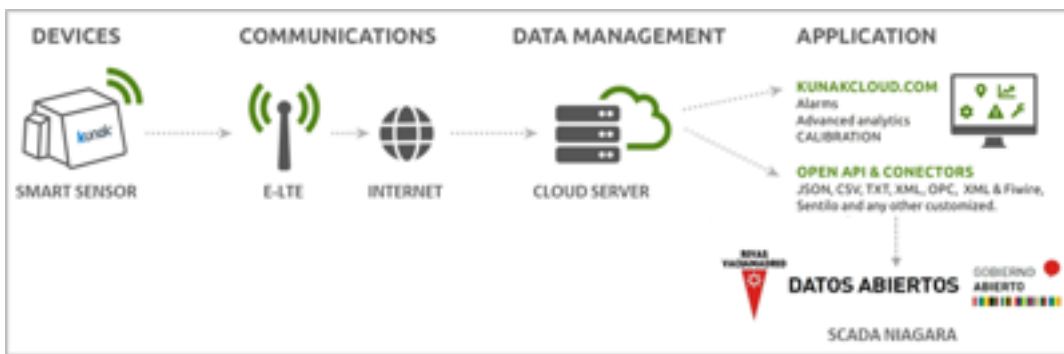
Figura A1-16 Esquema de comunicaciones de la red de sensores e integración en la vertical de calidad de aire (Caso de uso de Rivas Vaciamadrid) [35]
