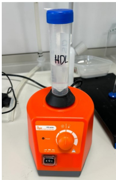
Figura 3-11 Agitador de tubos Ibx [autoría propia]
