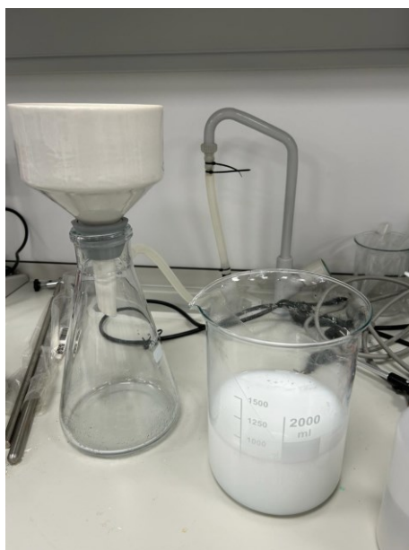
Figura 3-3 Embudo Büchner//Sistema Kisasato [autoría propia]
