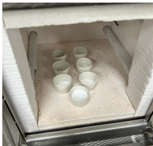
Figura 3-7 Muestras calcinadas en la mufla [autoría propia]
