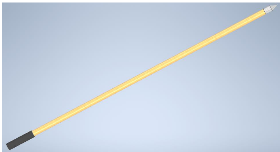
Figura 5-21 Diseño de la lanza de descarga electrostática
