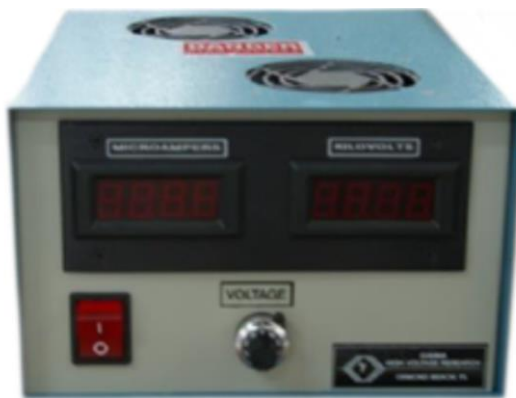
Figura 5-19 Fuente de tensión escogida
