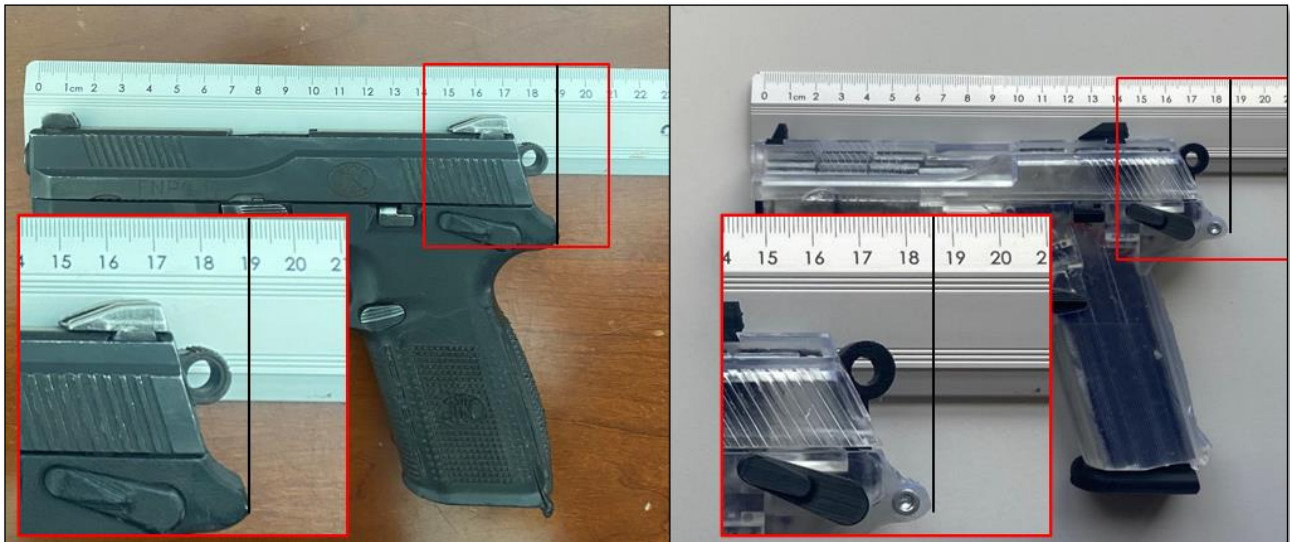
Figura 4-4 - Comparación entre la longitud de la FN-P9-17 (izquierda) y la de la réplica (derecha)
