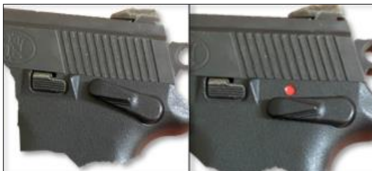
Figura 3-6 - Detalles del seguro activado (izquierda) y desactivado (derecha)
