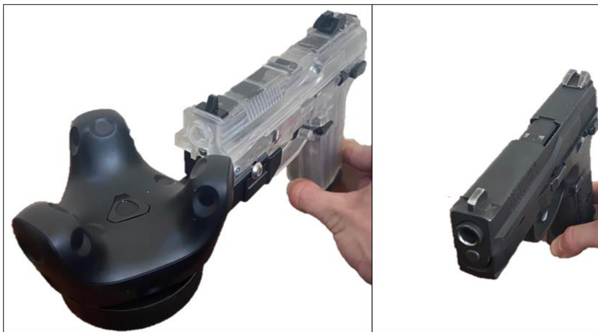
Figura 4-11 – Comparación visual de la réplica frente a la FN-P9-17
