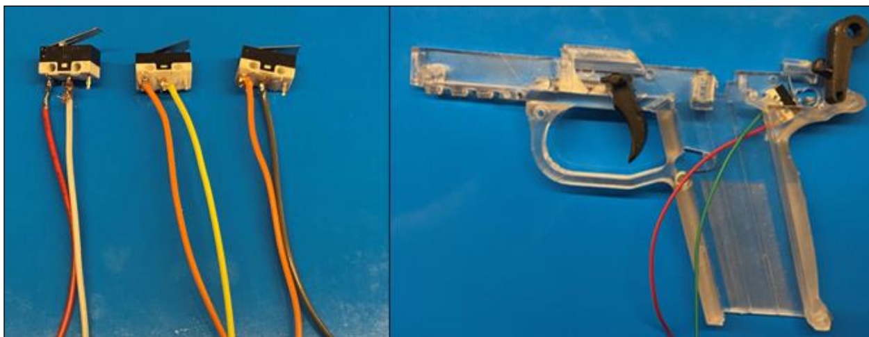
Figura 3-44 - Montaje de los elementos eléctricos y de elementos del cuerpo derecho del pistolete
