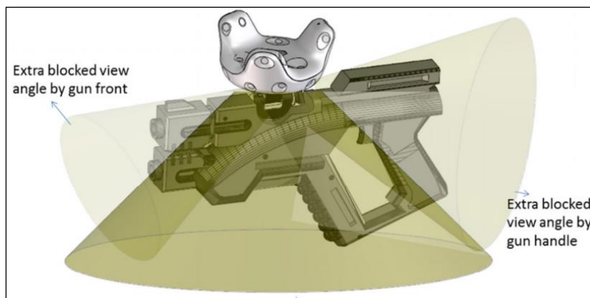
Figura 3-10 - Diagrama de arma corta con Vive Tracker 3 integrado [22]
