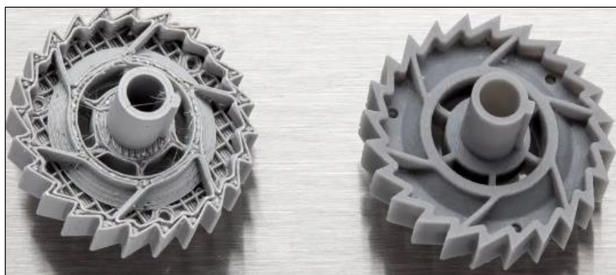
Figura 2-14 - Comparativa FDM (izquierda) frente a SLA (derecha) [25]
