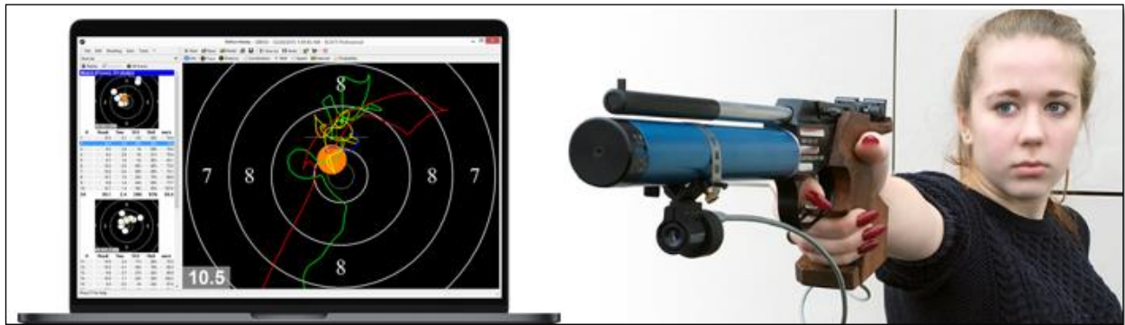
Figura 2-7 - Software y hardware del simulador SCATT [14]
