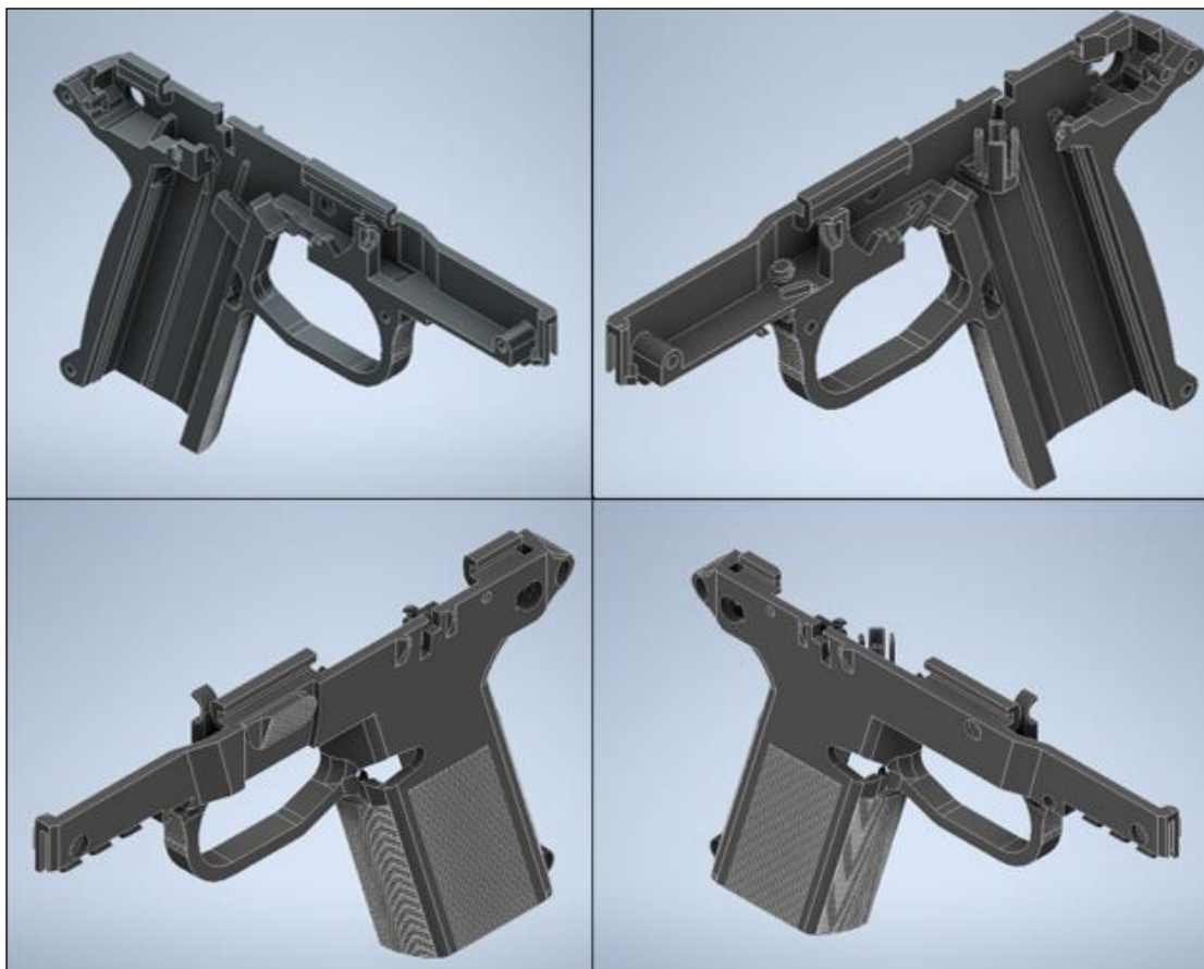
Figura 3-11 - Vista isométrica de los lados derecho e izquierdo del cuerpo del pistolete
