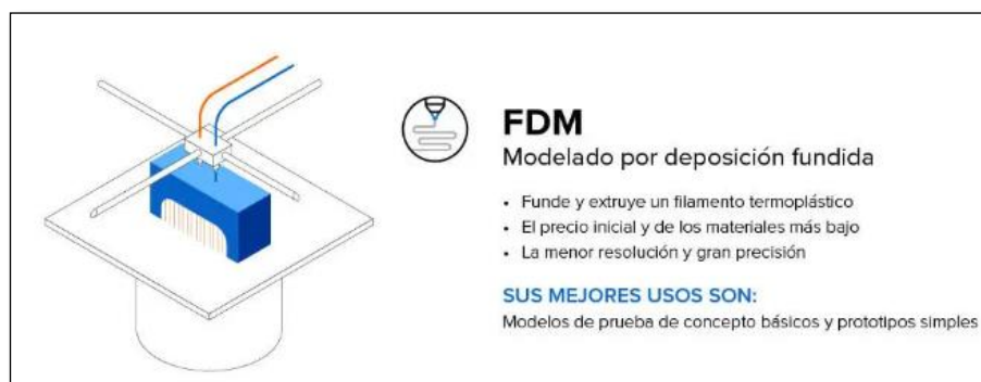
Figura 2-13 - Características de la impresión FDM [24]
