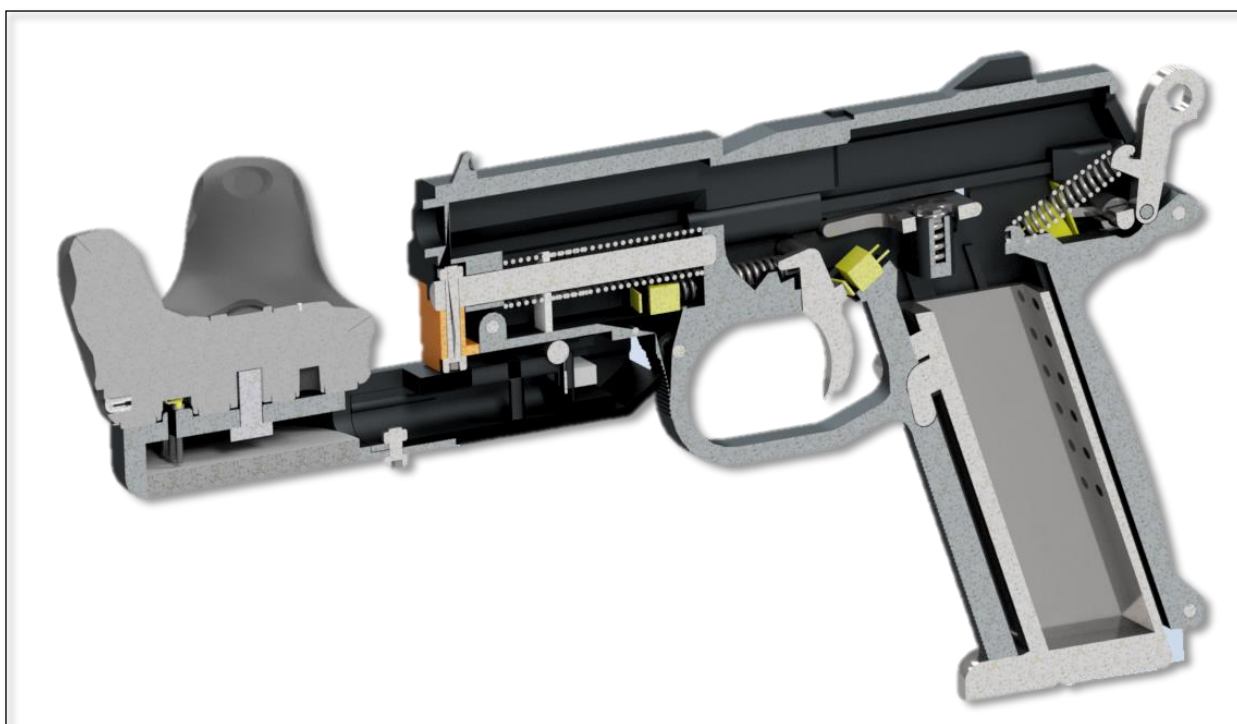
Figura 4-2 – Renderizado de sección transversal de la réplica
