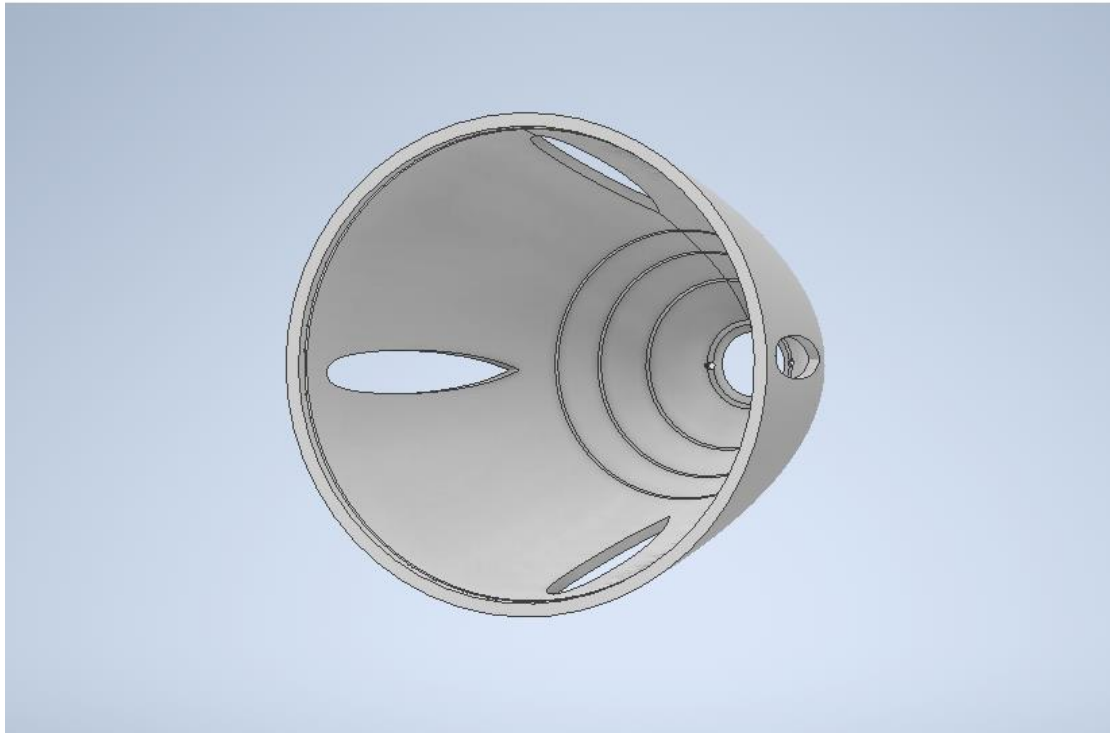
Figura 3-3 Cuerpo con agujeros para fijar la hélice. (autoría propia)
