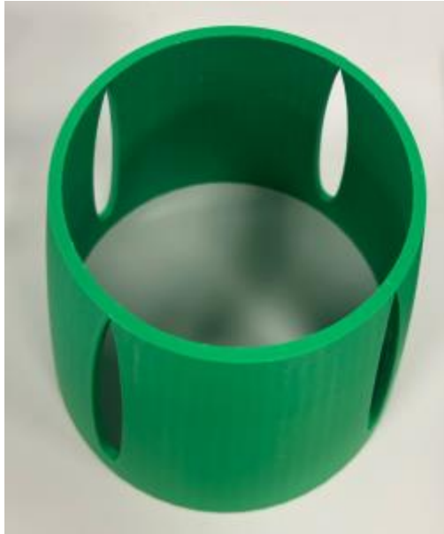
Figura 3-11 Primera mitad del cuerpo impresa (autoría propia)
