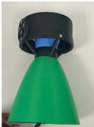
Figura 3-13 Segunda mitad del cuerpo impresa con la hélice acoplada (autoría propia)
