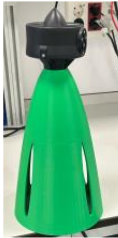
Figura 3-14 Cuerpo estructural con la hélice (autoría propia)
