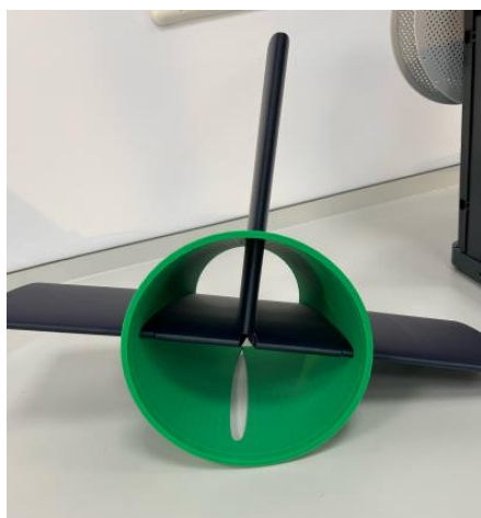
Figura 3-23 Cuerpo con aleta superior y principal (autoría propia)
