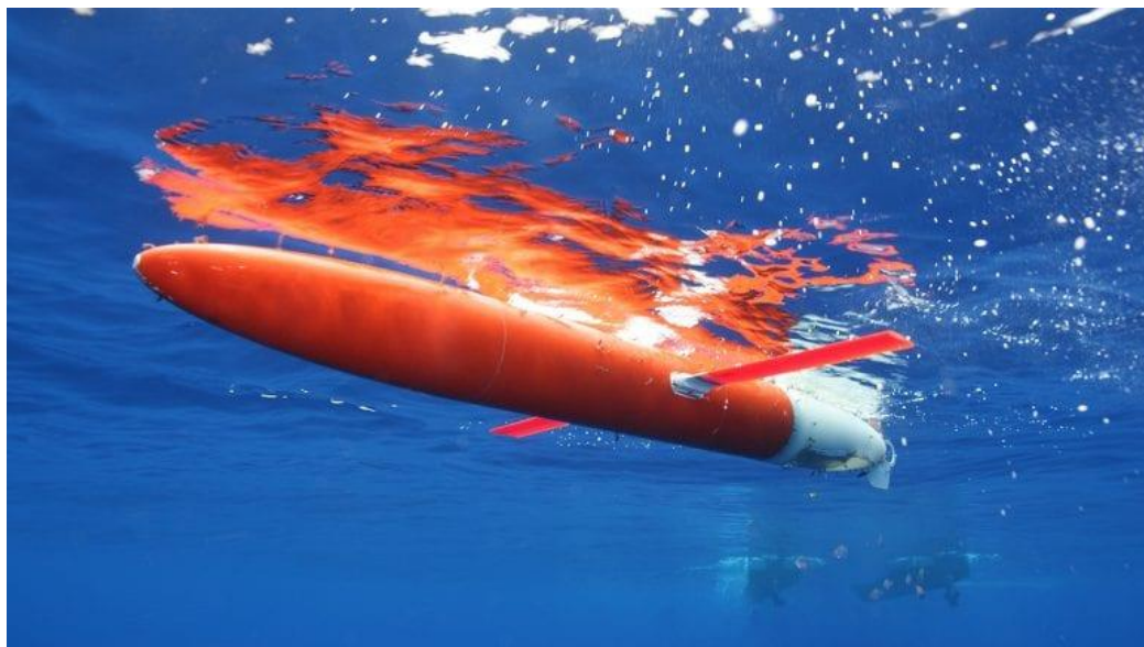
Figura 2-16 Spray Glider con capacidad de navegar sin límite de profundidad [24]
