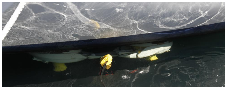
Figura 1-2 Robot Subacuático Lappa para Inspección y Mantenimiento de cascos [4]
