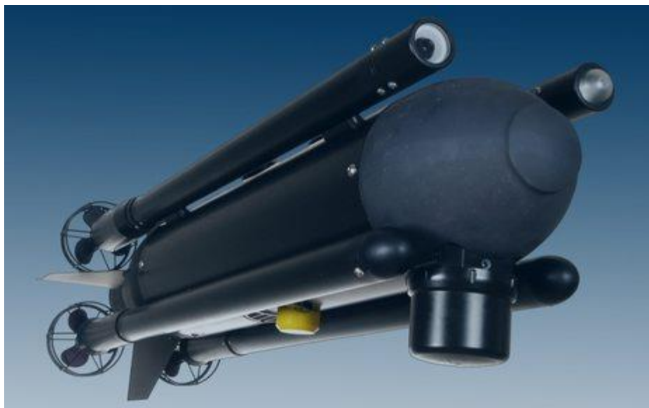
Figura 2-9 Sistema Contramedida antiminas ROUV Seafox [19]
