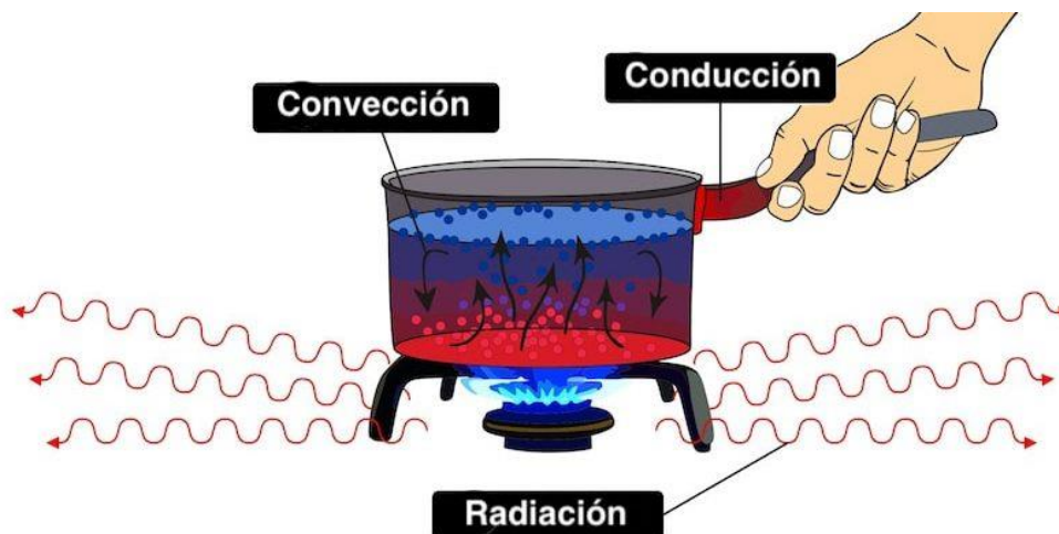
Figura 2-2 Transferencia de calor [18]
