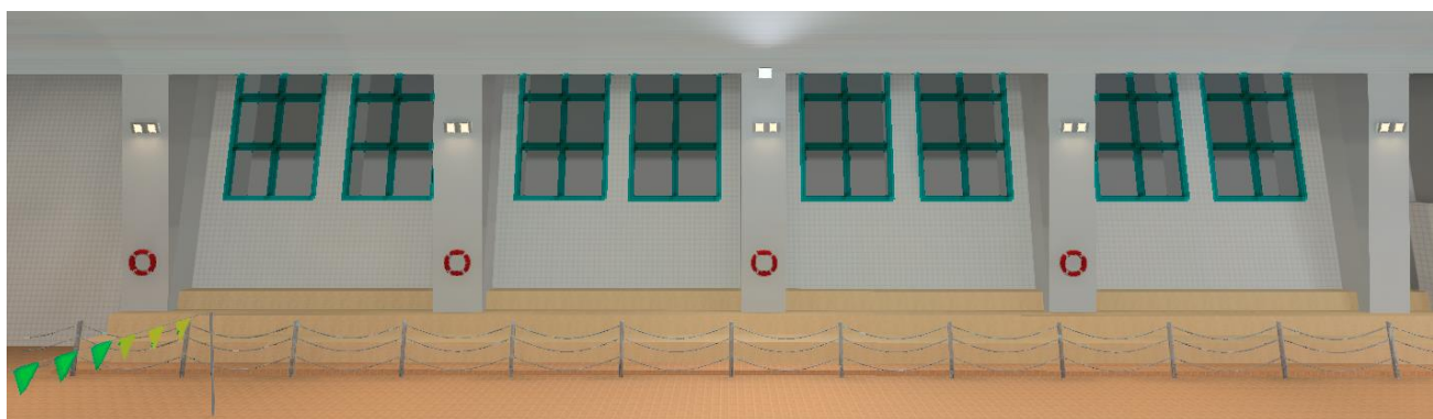
Figura 4-24 Disposición de las nuevas luminarias colocadas sobre la columna central
