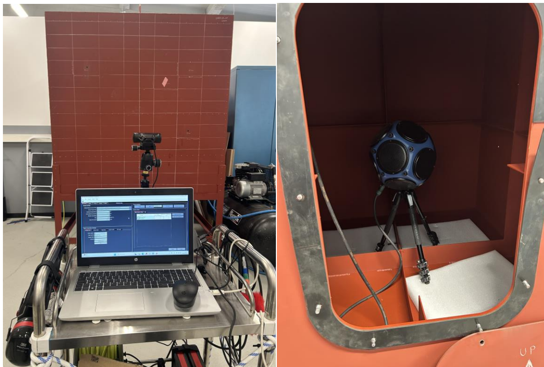
Figura 5-3 Montaje del equipo Scan & Paint . (Elaboración propia).
