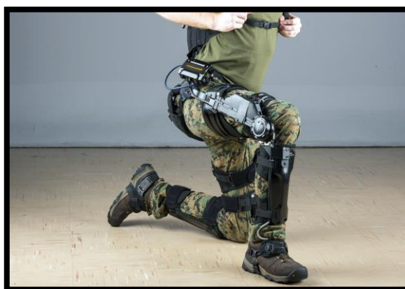
Figura 2-6 Exoesqueleto Lockheed Martin FORTIS para aliviar el estrés de la rodilla [9]
