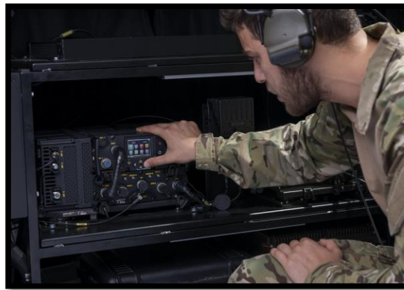
Figura 2-3 Sistema de radio definido por software SDR para vehículos E-Lynx de Elbit systems [5]
