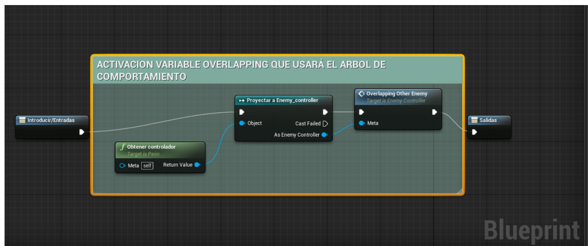
Blueprints de control del enemigo cuando se superpone a otro enemigo desglosado
