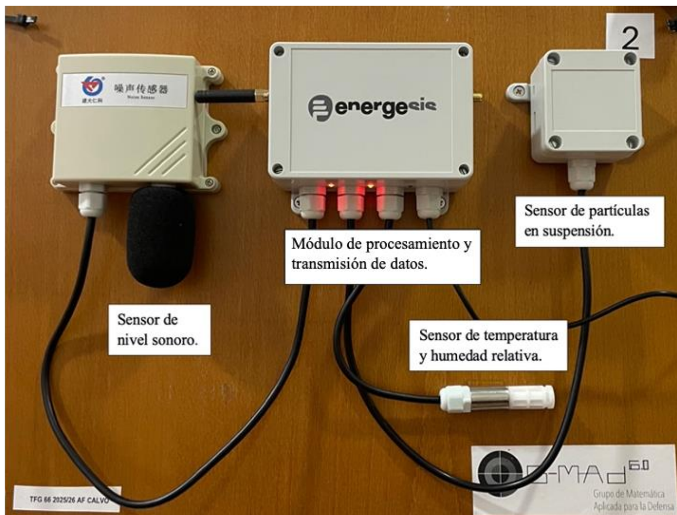
Figura 3-5 Disposición de los sensores. (Autoría propia)
