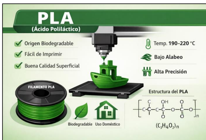
Figura 3-18 Representación esquemática del PLA [Autoría propia mediante IA]
