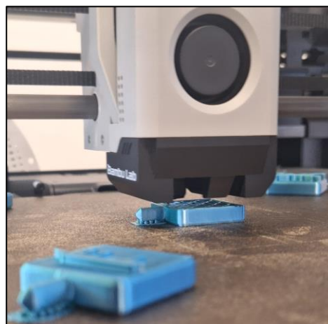
Figura 3-23 Impresora formando patrón de rejilla [Autoría propia]
