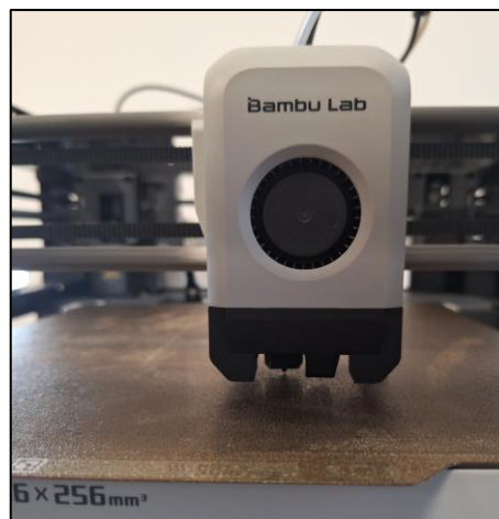
Figura 3-24 Impresora llevando a cabo el calibrado sobre la placa [Autoría propia]
