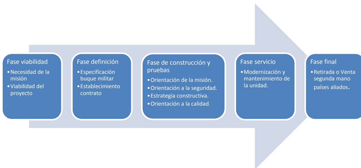
Figura 3-33 Proceso de construcción de un buque militar. Elaboración propia.
