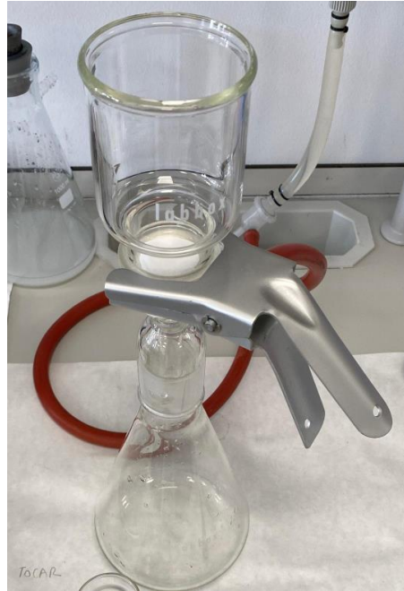
Figura 3-7 Sistema de filtración por vacío
