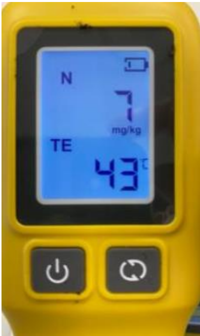
Figura 4-2 Valor de nitrógeno presente en la muestra sometida a 100°C durante 60 minutos
