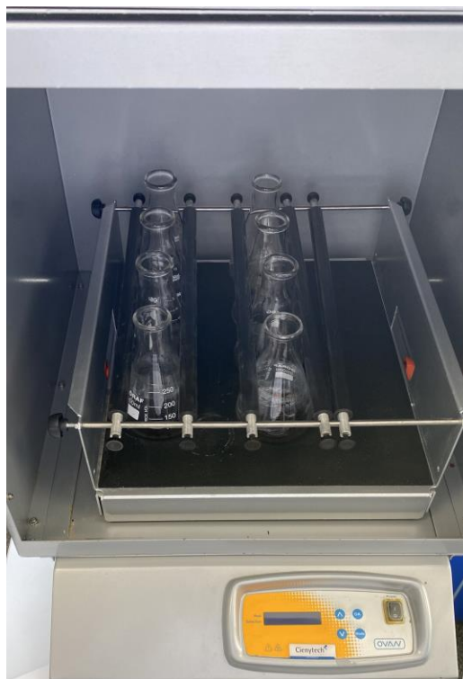
Figura 3-6 Agitadora Cienytech para preparación de mezcla
