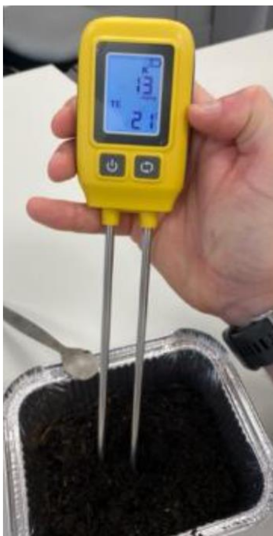
Figura 4-1 Valor de potasio presente en la muestra sometida a 100°C durante 5 minutos
