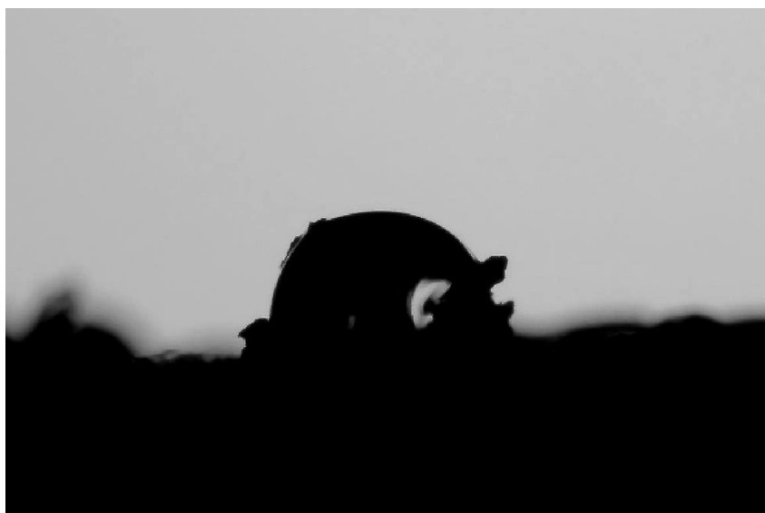
Figura 3-9 Captura de prueba con muestra de suelo tratado a 300°C durante 60 minutos
