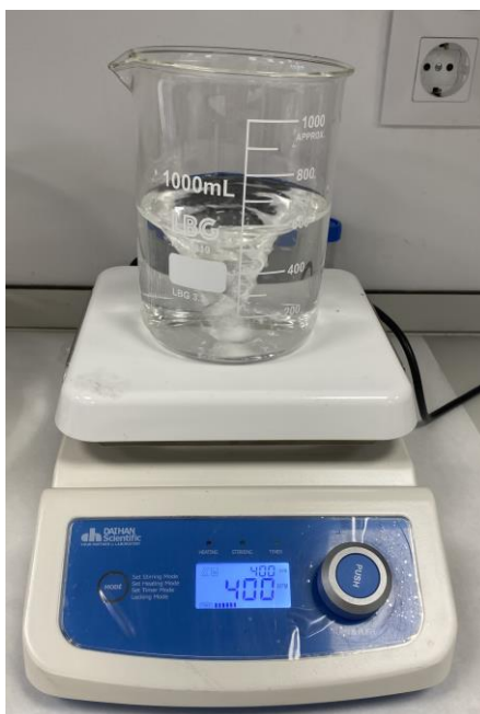
Figura 3-11 Agitado mezcla a 400 rpm
