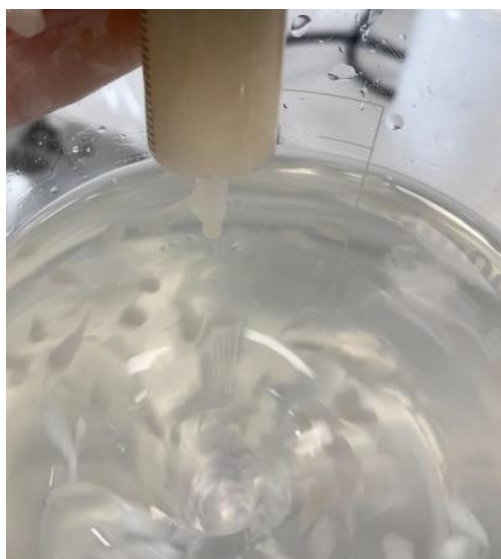
Figura 3-19 Creación de perlas de hidrotalcita
