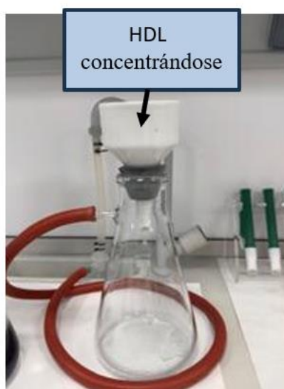
Figura 3-13 Montaje filtración de hidrotalcita
