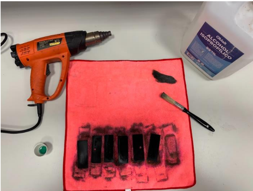
Figura 3-11 Elementos necesarios para la realización del pavonado en frío con ácido comercial (elaboración propia)
