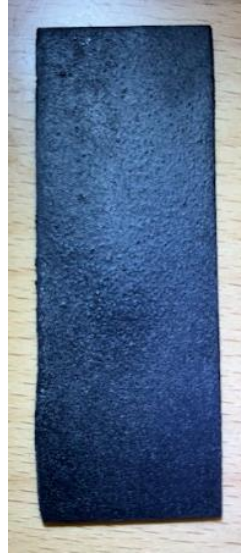
Figura 3-15 Pieza final pavonado con aerosol Tecnanblue™ (elaboración propia)
