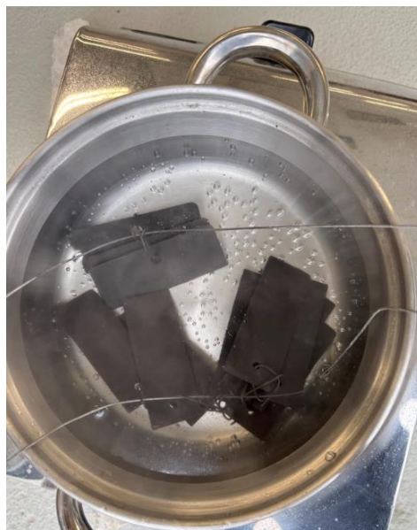
Figura 3-7 Piezas en agua en ebullición tras el fosfatado (elaboración propia)
