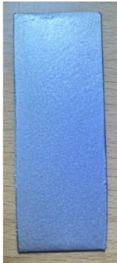
Figura 3-24 Pieza final zincado en frío (elaboración propia)
