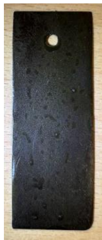
Figura 3-10 Pieza fosfatada con cataforesis finalizada (elaboración propia)
