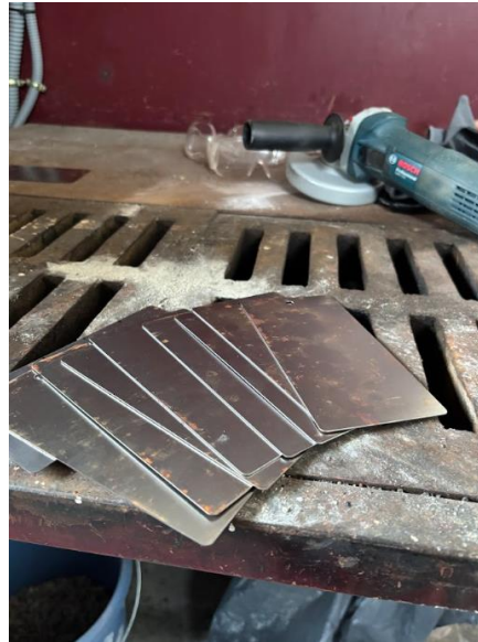
Figura 3-1 Estado original de las planchas de acero previo al pulido (elaboración propia)
