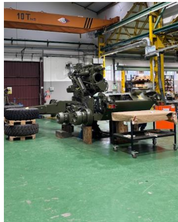
Figura A3 - 28 Montaje de la tras tratamiento superficial
