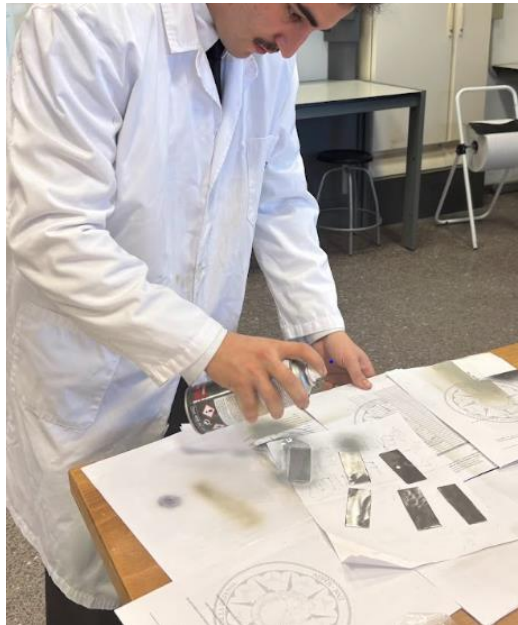
Figura 3-25 Aplicación de zincado en frío a las piezas de acero (elaboración propia)
