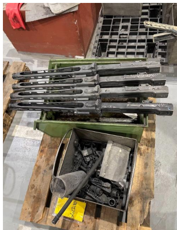
Figura A3 - 7 Ametralladora ligera MG3 desmontada y preparada para su desengrasado
