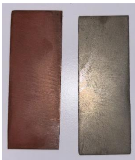
Figura 3-22 Pieza cobreada (izquierda) y pieza tras el niquelado (derecha) (elaboración propia)
