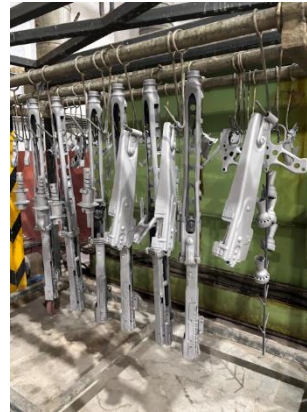
Figura A3 - 13 Estado final tras arenado / granallado
