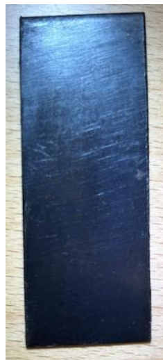
Figura 3-12 Pieza final pavonado en frío con ácido comercial (elaboración propia)
