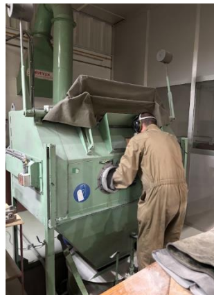
Figura A3 - 11 Máquina de arenado operada por el operador para la limpieza de la parte exterior de la serie de MG3
