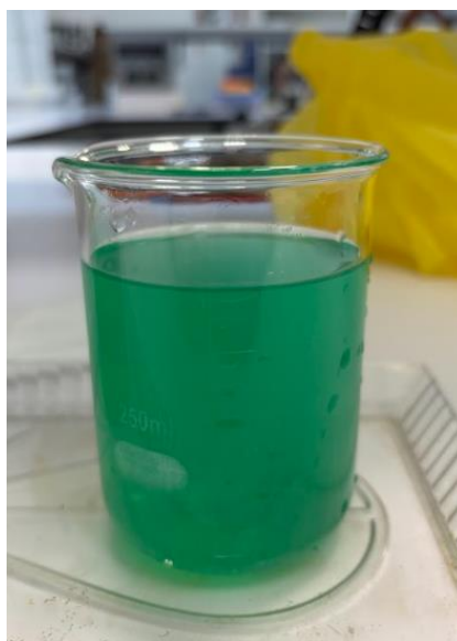
Figura 3-20 Electrolito de níquel formado de color verde azulado (elaboración propia)
