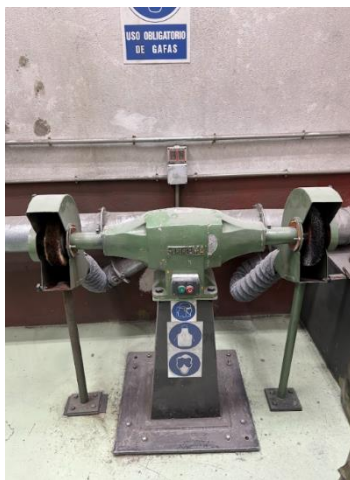
Figura A3 - 14 Rodillos de limpieza de piezas para pavonado
