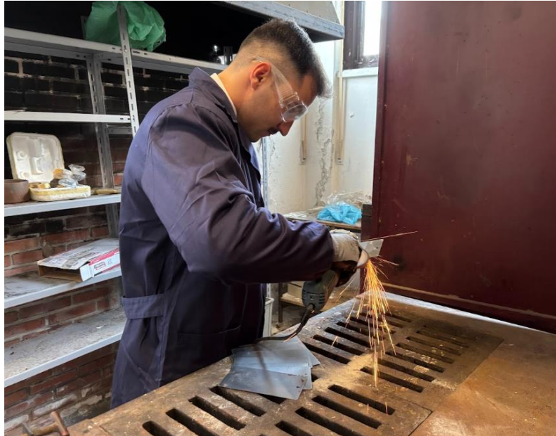
Figura 3-2 Pulido de planchas de acero (elaboración propia)
