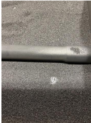
Figura A3 - 12 Granos de granalla junto a cañón 12,7mm
