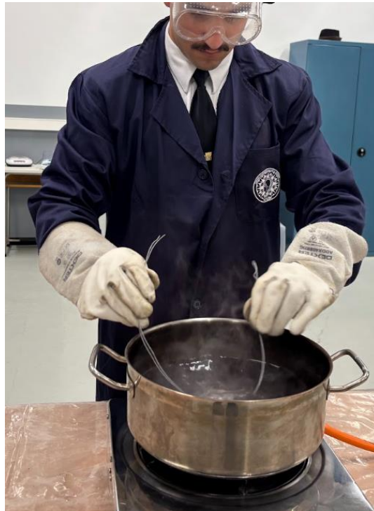
Figura 3-6 Comprobación y agitado de piezas durante el fosfatado (elaboración propia)
