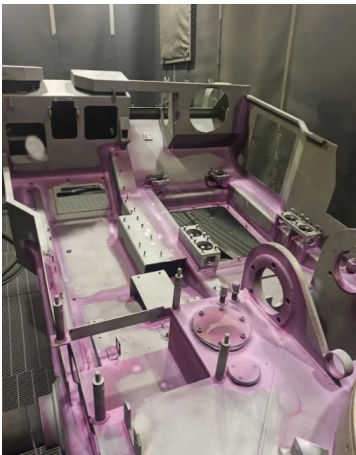
Figura A3 - 26 Comprobación de soldaduras con líquido penetrante
