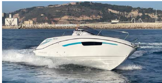
Figura 2-16 Un ejemplo de casco semi-planeador es el de la Rodman Ventura 790 SD [30]
