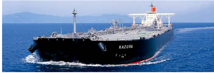
Figura 2-15 Un ejemplo de casco de desplazamiento es el del petrolero VLCC Kazusa [28]
