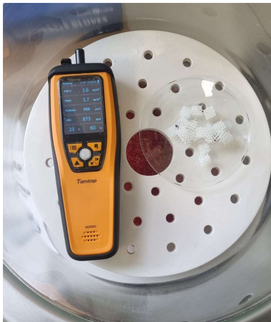
Figura 4-12 Ensayo de adsorción de \text{CO}_2 en cámara cerrada con medidor M2000C y filtros 0 % de alga
