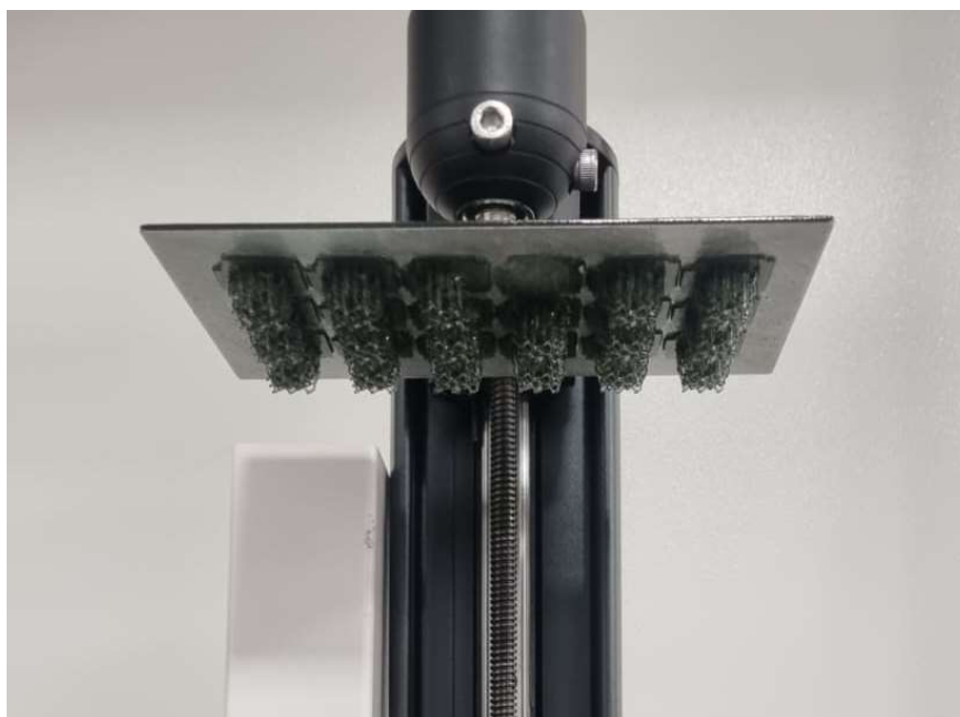
Figura 4-7 Piezas impresas adheridas a la placa de construcción tras el proceso de impresión.
