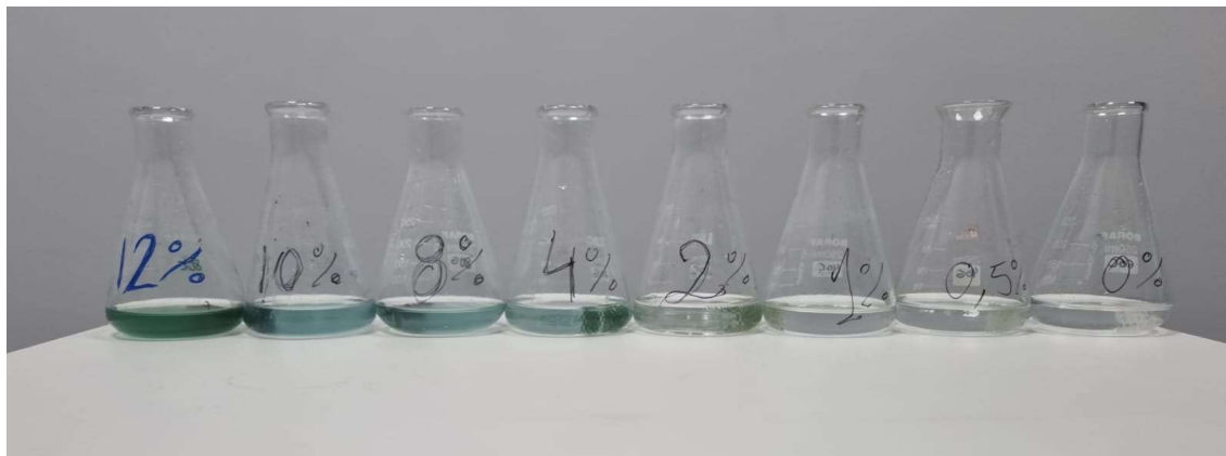
Figura 5-18 Aspecto de las disoluciones de fosfato tras 30 minutos de contacto con filtros de distinto contenido de biomasa microalgal.
