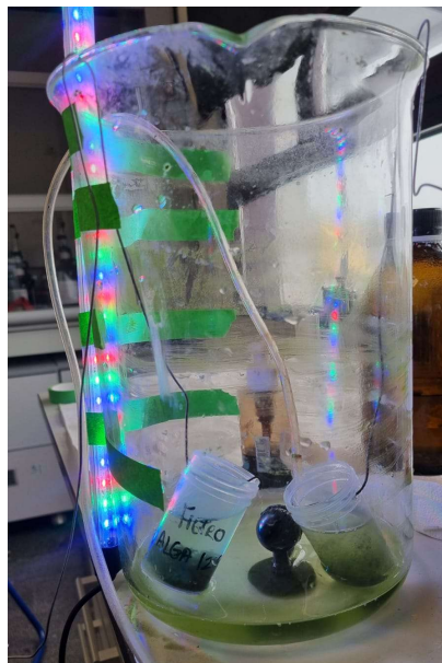
Figura 4-9 Montaje utilizado para el ensayo de adhesión de microalgas
