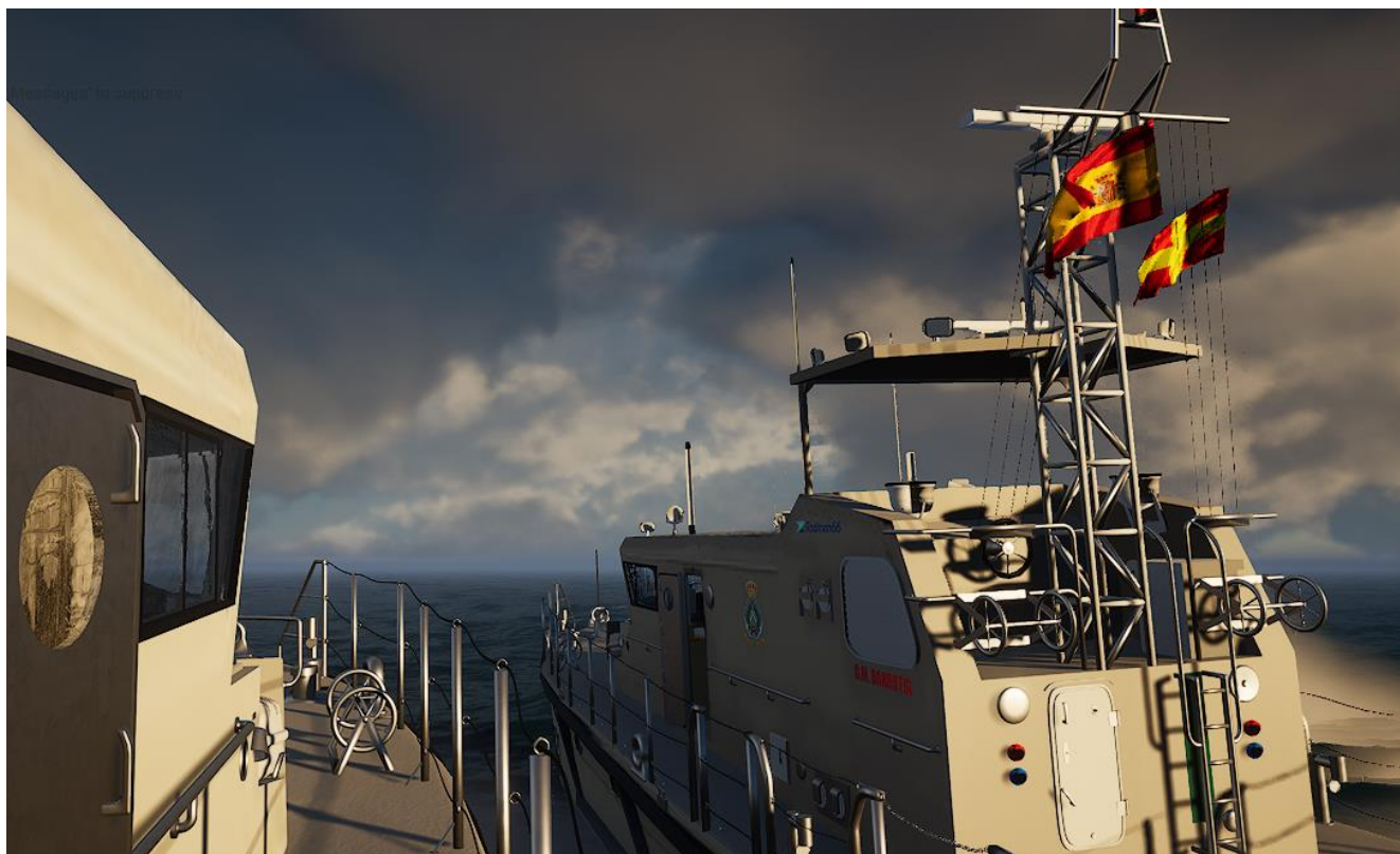
Figura 3-17 Buque receptor manteniendo posición a babor del proveedor (Elaboración propia)
