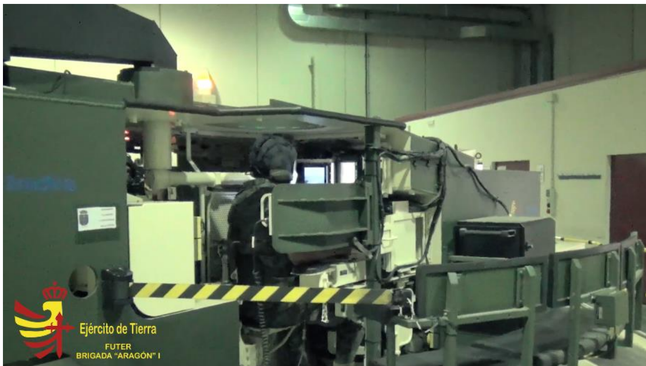
Figura 2-4 Simulador de torre de carro de combate Leopard. Ejército de Tierra [31]
