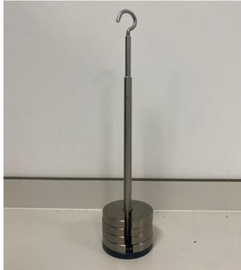
Figura 3-7 Sistema de pesos calibrados (autoría propia).
