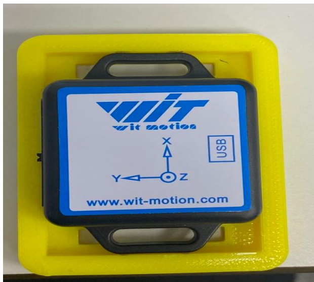
Figura 3-5 Soporte del acelerómetro extruido en PLA (autoría propia).
