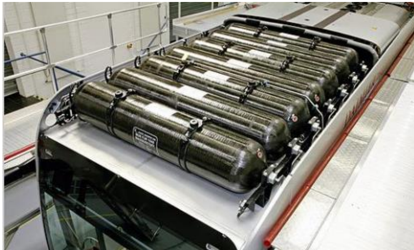
Figura 5-2 Disposición modurable depósitos hidrógeno [65].
