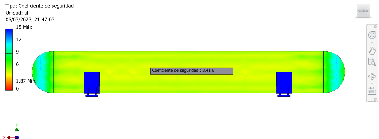
Figura 4-13 Coeficiente seguridad depósito SA 106 C.
