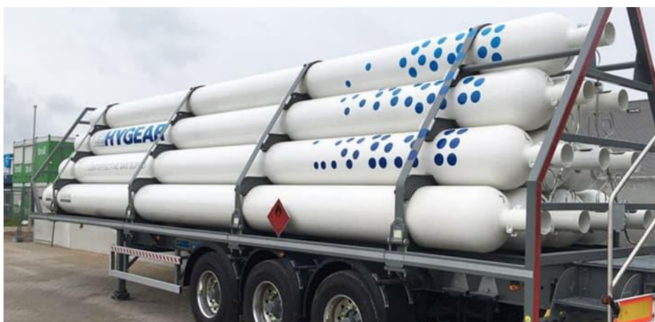
Figura 3-4 Depósitos cilíndricos de hidrógeno comprimido [49].
