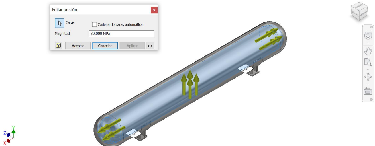
Figura 4-10 Restricción y presión aplicadas sobre el depósito.
