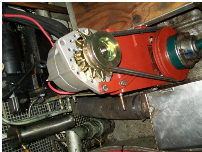
Figura 2-6 Alternador accionado por el eje propulsor ( www.cruisersforum.com )
