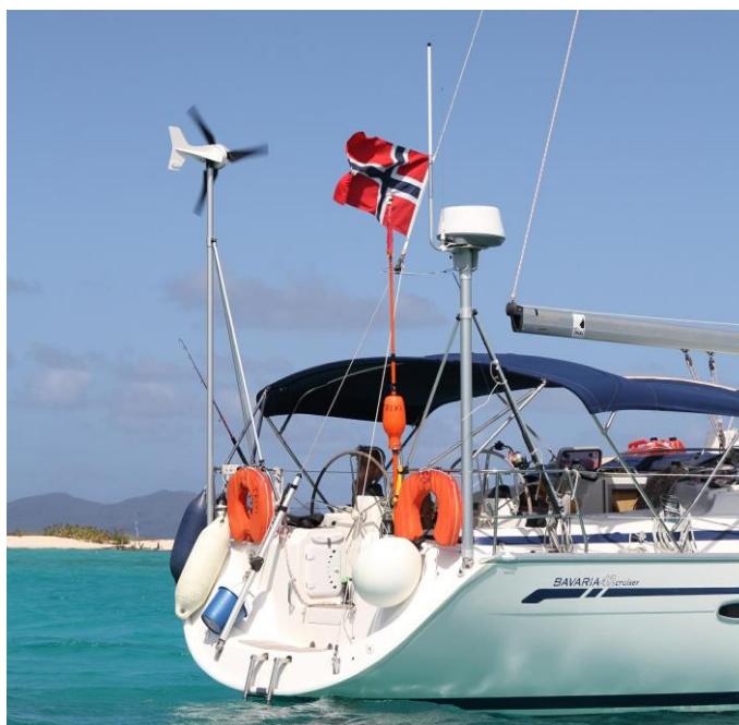
Figura 2-5 Aerogenerador sobre una embarcación de recreo ( www.leadingedgepower.com )
