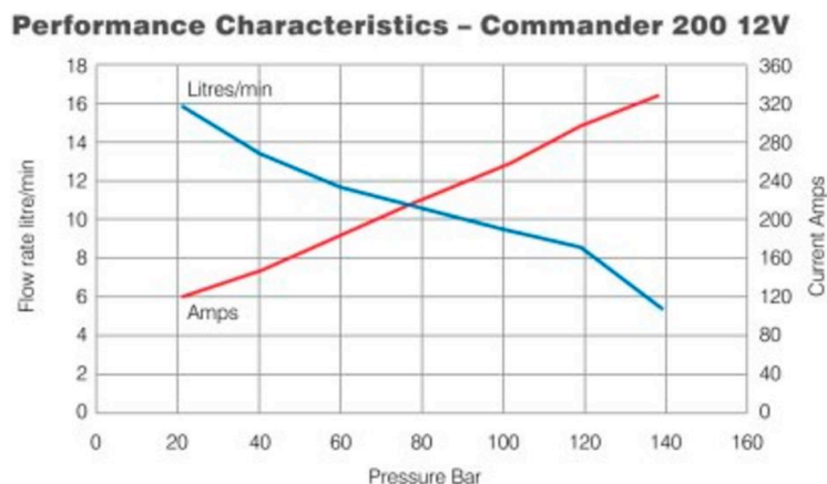
Figura 3-3 Gráfico de rendimiento del motor electro-hidráulico ( www.lewmar.com )
