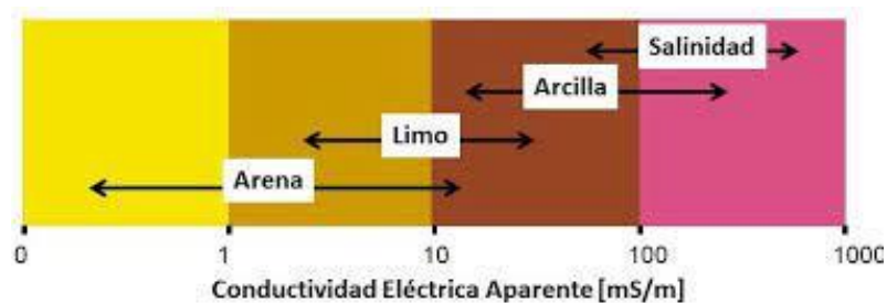
Figura 3-2 Esquema conductividad eléctrica por tipo de suelo [50]
