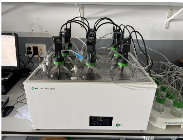
Figura 3-14 Experimento 3 en funcionamiento en el AMPTS III
