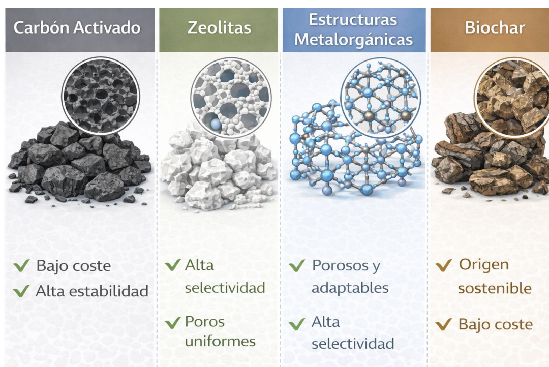
Figura 2-9: Comparación estructural de distintos materiales adsorbentes [generada con ChatGPT].
