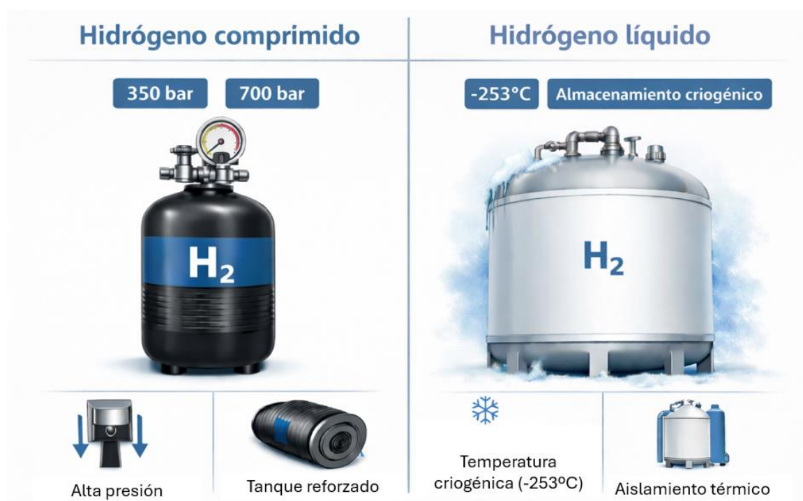
Figura 2-13: Métodos de almacenamiento físico de hidrógeno: hidrógeno comprimido e hidrógeno líquido [generada con ChatGPT].
