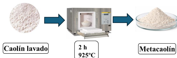
Figura 3-2: Proceso de calcinación del caolín para la obtención de metacaolín.
