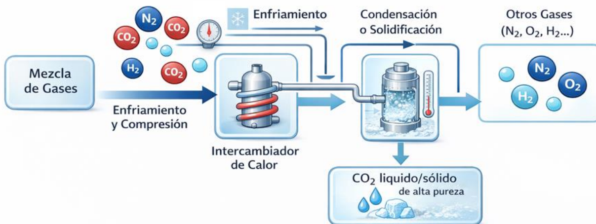
Figura 2-7: Esquema de proceso criogénico para separar CO 2 [generada con ChatGPT].
