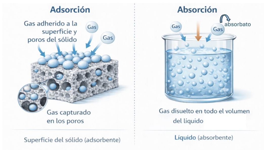
Figura 2-8: Representación conceptual de los mecanismos de captura de CO 2 mediante absorción y adsorción [generada con ChatGPT].
