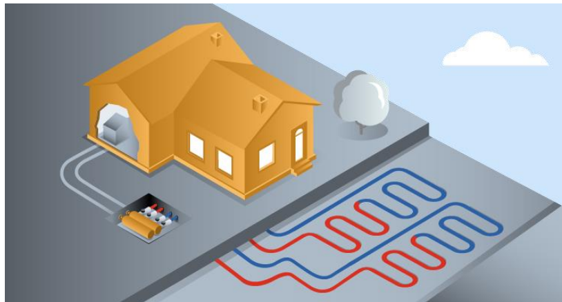
Figura 2-4 Esquema de la instalación geotérmica horizontal. (Fuente: [23])
