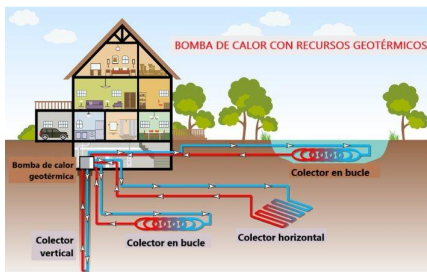
Figura 2-3 Tipos de sistemas de captación. (Fuente: [22])
