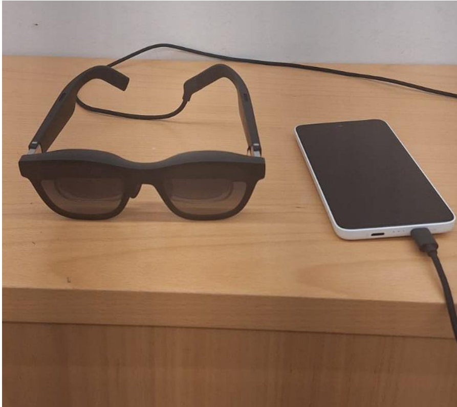
Figura 3-2 Gafas XREAL Air 2 con el dispositivo XREAL Beam Pro (Elaboración propia)
