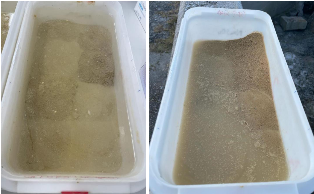
Figura 4-6 Morteros de cal descompuestos tras proceso de desalinización
