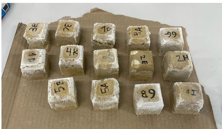
Figura 4-3 Muestras de cal tras el primer ciclo de alteración por sales
