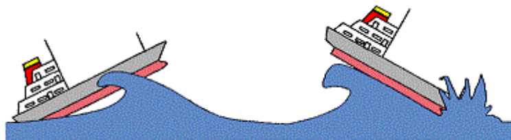
Figura 2-3 Movimiento de cabezada [5]
