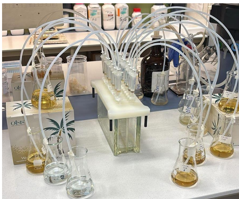
Figura 3-26. Muestras pasando por los cartuchos, donde se quedan retenidos los fármacos
