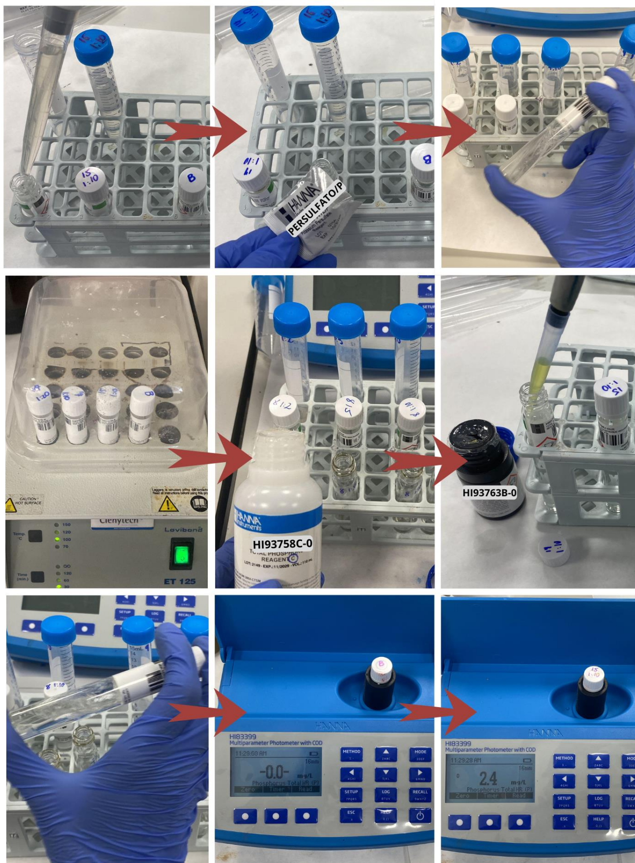
Figura 3-23. Pasos para la cuantificación del fósforo (elaboración propia)
