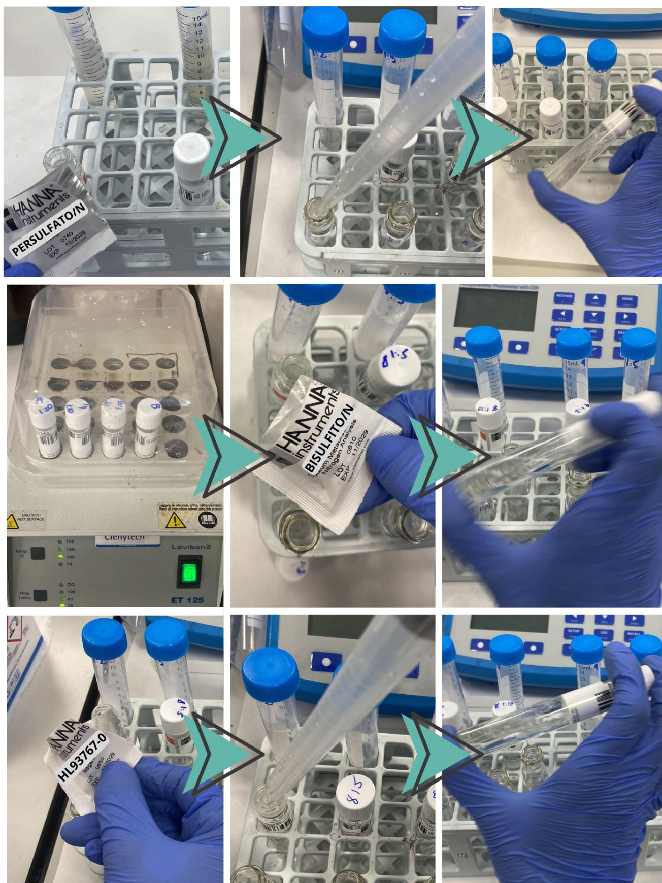
Figura 3-22. Proceso seguido para la cuantificación del nitrógeno (elaboración propia)
