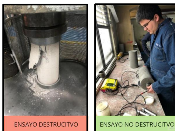
Figura 2-6 Ensayo destructivo por compresión y no destructivo por ultrasonidos en hormigón (Fuente: Universidad Católica del Ecuador) [9]
