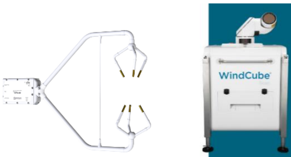
Figura 2-8: Medidores de velocidad y dirección del viento. A la Izquierda uno de la empresa Campbell Scientific y a la derecha uno más sofisticado de la empresa Vaisala [35] y [36]
