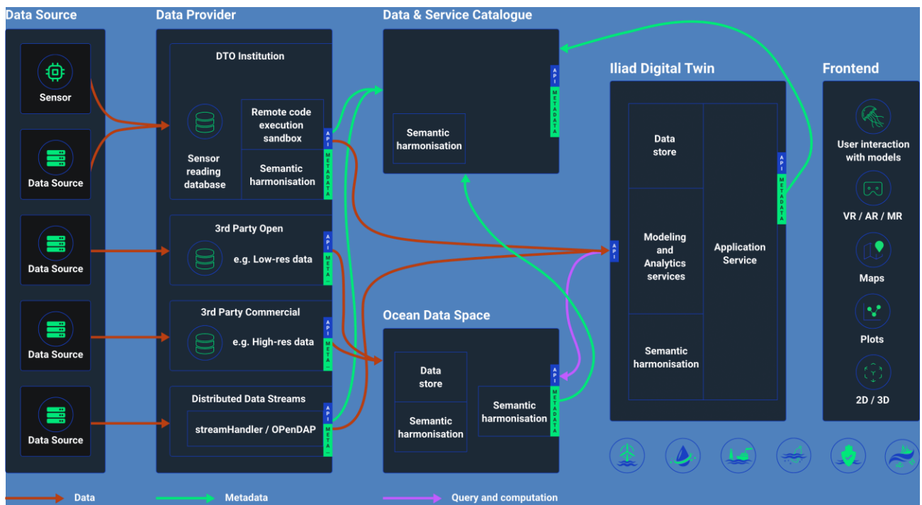
Figura 2-3: Diseño de una arquitectura del gemelo digital del océano [11]
