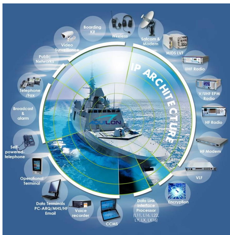
Figura 2-23: Representación gráfica de la arquitectura IP de comunicaciones navales de Thales [57]
