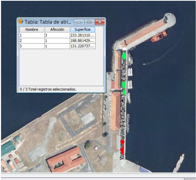
Figura 4-14: Zonas afectadas y sus superficies a 15 cm de profundidad
