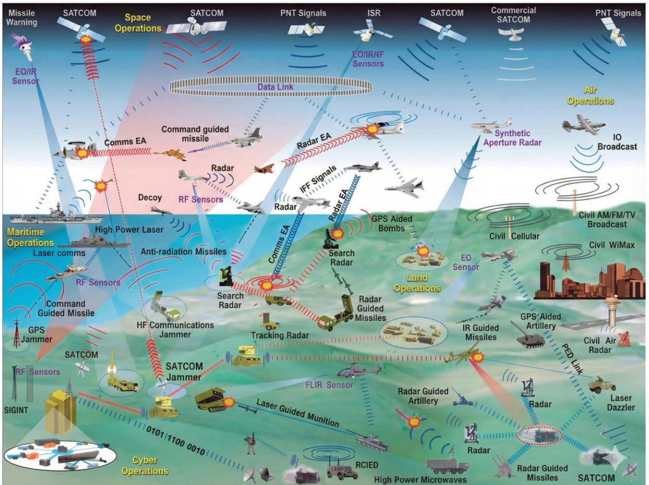
Figura 2-3 El entorno electromagnético (Fuente: AJP-3.6 Allied Joint Doctrine for EW )
