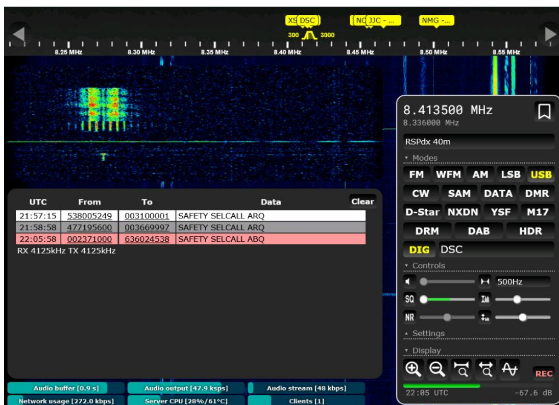
Figura 4-1 Decodificación de llamadas selectiva en OpenWebRX+ (Fuente: fms.komkon.org/OWRX/)
