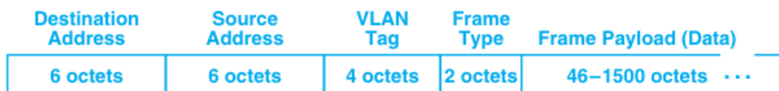
Figura 3-12: Formato de paquete Ethernet VLAN [28].
