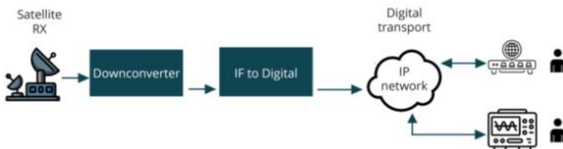
Figura 3-30: Caso de uso separación de módulo RF y antena de los equipos de procesamiento.
