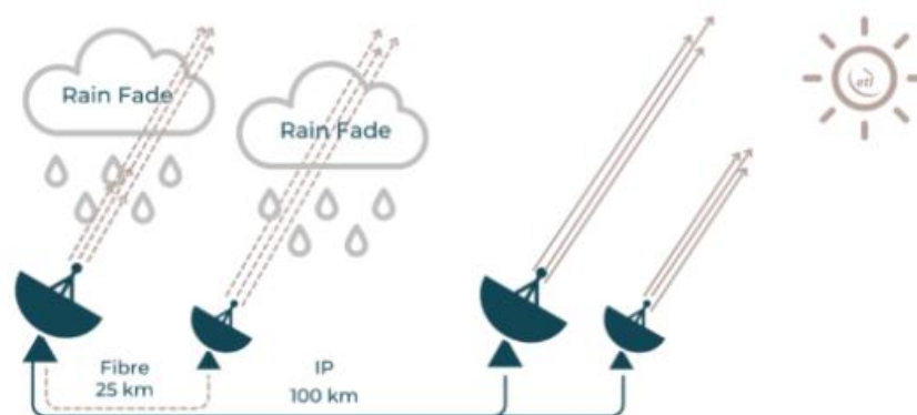
Figura 2-41: Ejemplo de redundancia de antenas [10].
