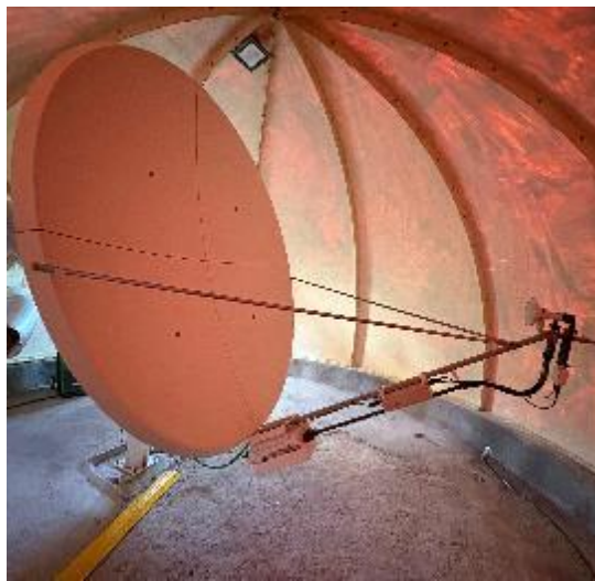
Figura 2-21: Ejemplo de módulo de antena en banda X en Isla de Alborán (transmisor y receptor).
