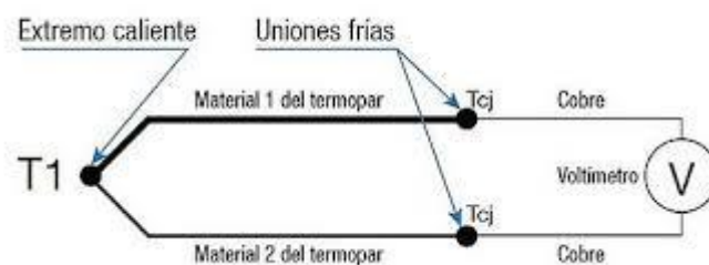
Figura 2-13 Esquema de un termopar [16].
