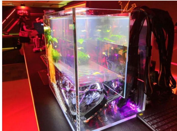
Figura 2-3 Data center sumergido [14]
