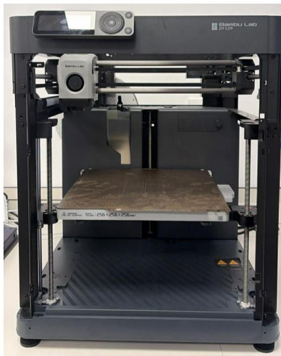
Figura 3-11 Impresora 3D Bambu Lab P1S empleada para la fabricación de las probetas experimentales mediante tecnología de deposición de filamento fundido (FFF) (Elaboración propia)
