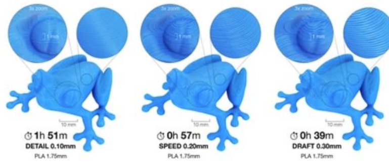
Figura 2-47 Efecto escalera en superficies inclinadas debido a la deposición capa a capa (Extraído de [124])
