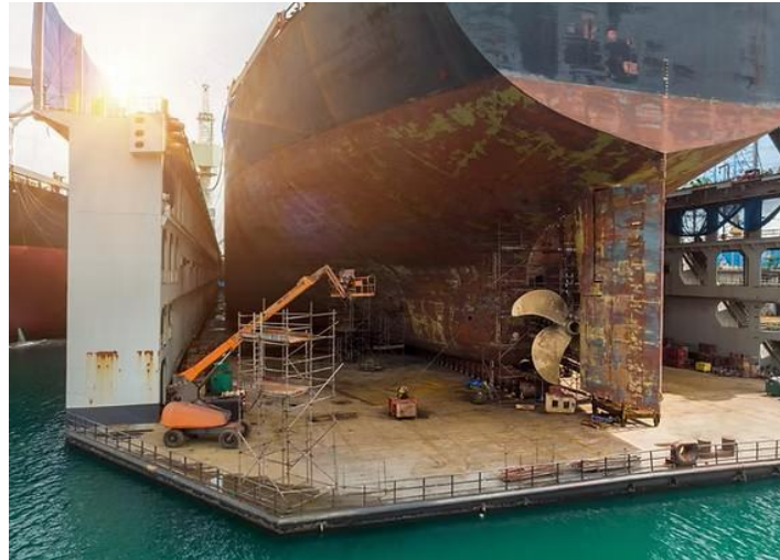
Figura 2-15 Un gran buque en dique seco con andamios y equipos que muestran detalles de su casco y hélice durante una sesión de reparación (Extraído de [46])
