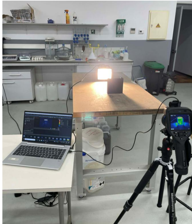
Figura 3-18 Montaje experimental utilizando la lámpara halógena de 500 W (Elaboración propia)
