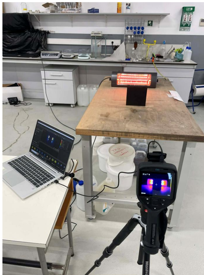
Figura 3-19 Montaje experimental utilizando la lámpara infrarroja de 2000 W (Elaboración propia)
