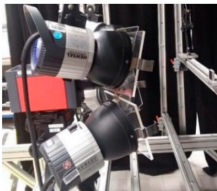
Figura 2-34 Configuración para termografía pulsada con cuatro lámparas flash (Extraído de [106])
