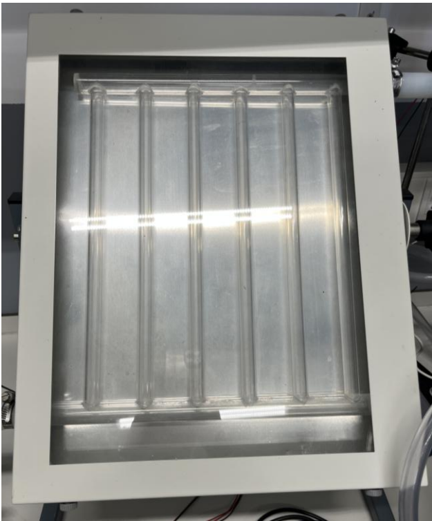
Figura 3-4 Colector solar (elaboración propia).
