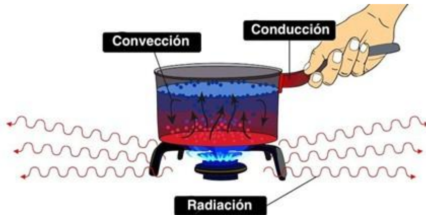
Figura 2-1 Transferencia de calor [3].
