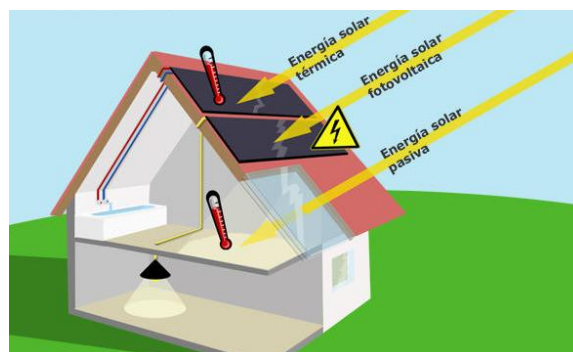
Figura 2-5 Energía solar pasiva [15].
